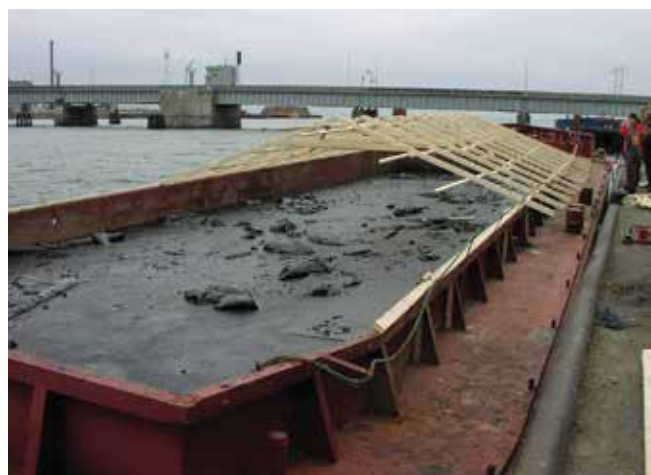
▲ Figure 10 : Hydrocarbures récupérés stockés dans une barge. Une couverture est nécessaire pour empêcher la pénétration de l'eau de pluie.
