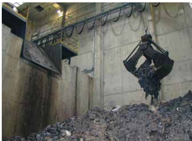
▲ Figure 19 : Sacs de déchets pollués introduits dans la trémie de chargement d'un grand incinérateur industriel pour la co-élimination avec les ordures ménagères.
