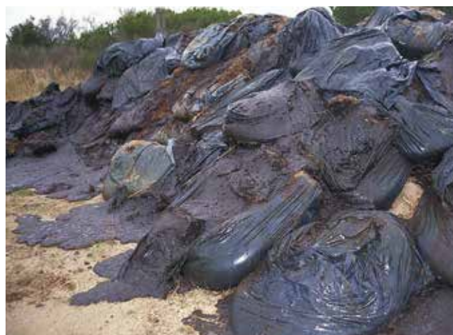
▲ Figure 12 : La dégradation de sacs en plastique par l'exposition prolongée au soleil peut causer des problèmes de recontamination.
