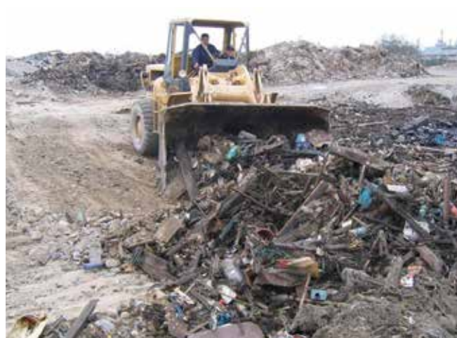
▲ Figure 14 : Le retrait des débris présents sur le littoral avant que les hydrocarbures ne s'échouent permet de réduire la quantité de produits pollués à éliminer.
