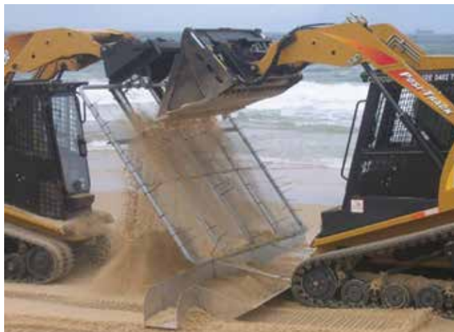
▲ Figure 17 : Criblage mécanique de boulettes d'hydrocarbure et de sable pour réduire la quantité de déchets générée.
