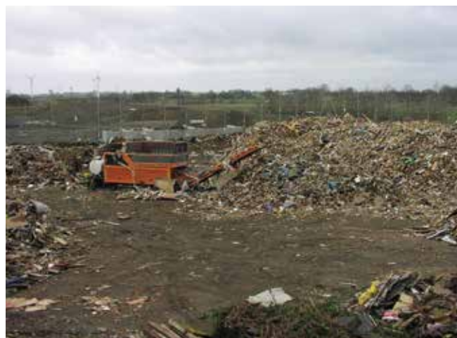
▲ Figure 20 : Décharge. Les déchets à faibles concentrations d'hydrocarbures peuvent être mis en décharge avec les ordures ménagères dans des conditions strictement contrôlées.
