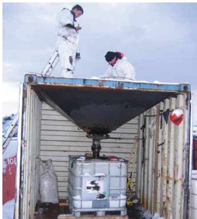
▲ Figure 16 : Système improvisé pour la filtration des déchets, consistant à faire passer l'hydrocarbure à travers un entonnoir métallique grillagé pour éliminer les débris.
