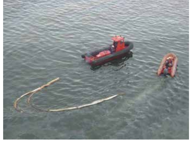
▲ Şekil 12: Denizde parlaklığın (çok ince petrol şeritleri) kaldırılması amacıyla iki geminin arkasında "U" biçiminde yedekte çekilen emici maddeden engel. Engelin deniz suyuna dolması verimliliğini sınırlandırmaktadır ve engelin eteğinin olmaması petrolü kontrol altına alma kabiliyetini sınırlandırmaktadır. Burada petrolün engelden kaçtığı görülebilmektedir.
