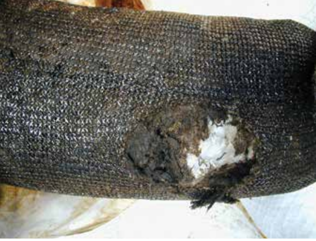
▲ Şekil 4: Sadece kısmi kullanımın gösterilmesi için kesilip ayrılan kesintisiz, homojen bir emici madde engelinin yüzeyi. Ya engelin yetersiz bir zaman dilimi boyunca yerleştirilmiş olması nedeniyle ya da petrolün yapının içerisine nüfuz etmek için çok akışmaz olması nedeniyle iç hacim petrol bulaşmamış bir şekilde kalmaktadır.
