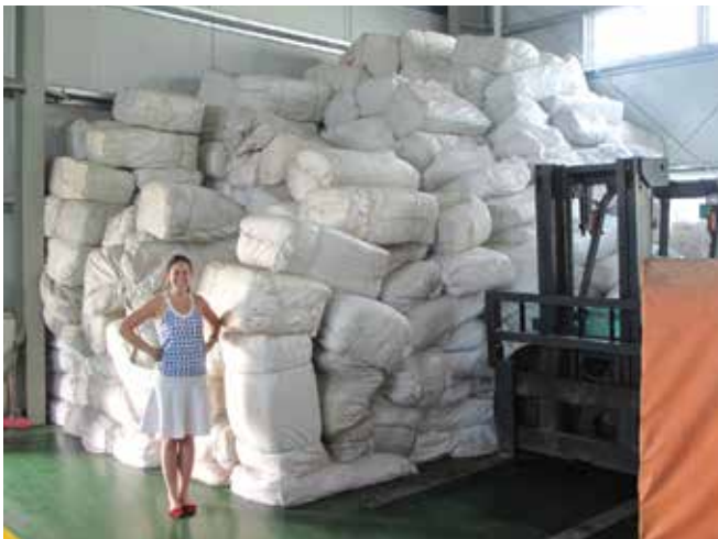
▲ Şekil 8. Emici maddeler nitelikleri gereği hacimli ürünlerdir. Bir kazara dökülmeye müdahaleden önce, müdahale boyunca ve sonrasında depolama ve nakliye ikmal ve maliyet sorunları ortaya koyabilmektedir.
