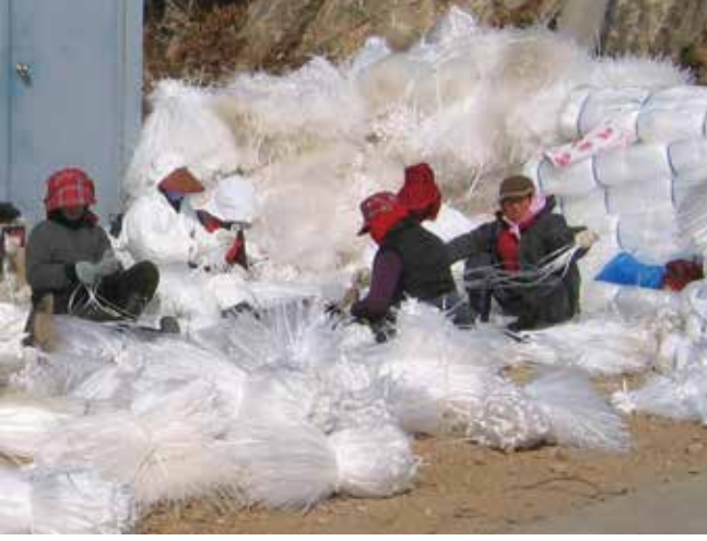
▲ Şekil 6: Polipropilen şeritlerinden kapanlar inşa eden yerel köylüler. Yerel olarak elde edilebilen malzemelerden emici malzeme imalatı fiyat anlamında olduğu kadar nakliye verimliliği anlamında da uygun maliyetli olabilmektedir.
