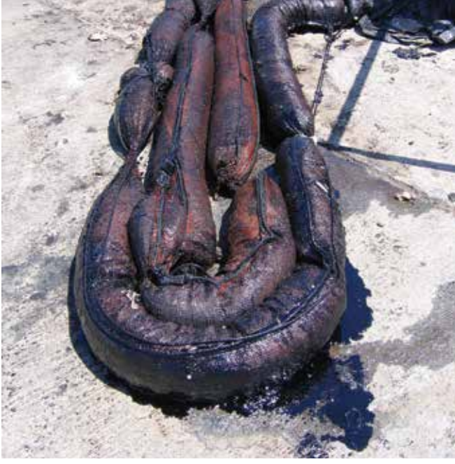
▲ Şekil 14: Toplanan bir emici maddeden engelden sızan petrol ikinci bir kirlilik kaynağı olmaktadır.
