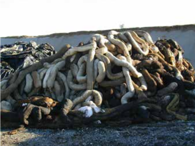
▲ Şekil 15: Geçici bir depolama sahasında istiflenen kullanılmış emici madde. Sıkıştırma toplanan petrolün engelden sıklmasına yol açmaktadır ve ikinci bir kirlenmenin önlenmesi için dikkat gösterilmesine ihtiyaç olmaktadır.
