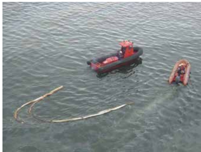
▲ Рис. 12: Сорбирующий бон, буксируемый по "U"-образной схеме двумя судами с целью удаления блеска (очень тонкой нефтяной пленки) в открытом море. Насыщение бона морской водой ограничивает его эффективность, а отсутствие юбки на боне ограничивает его способность сдерживать нефть. На данном снимке видно, как нефть не сдерживается и остается позади бона.
