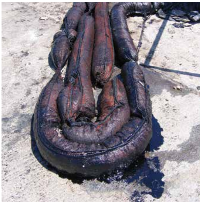
▲ Рис. 14: Нефть, просачивающаяся через насыщенный сорбирующий бон, представляет собой источник вторичного загрязнения.
