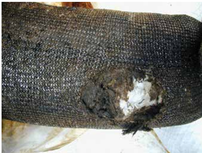
▲ Рис. 4: Поверхность сплошного гомогенного сорбирующего бона была срезана, чтобы показать его лишь частичное насыщение. Материал внутри бона остался незагрязненным либо потому, что бон оставался развернутым в течение недостаточного периода времени, либо потому, что нефть слишком вязкая для проникновения в структуру.
