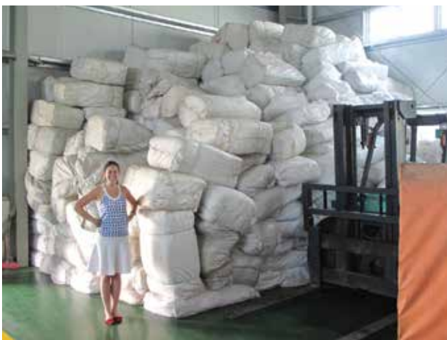
▲ Рис. 8: Сорбентные материалы по своей природе являются объемными материалами. Хранение и транспортировка до, во время и после устранения разлива может выдвинуть проблемы логистики и затрат.
