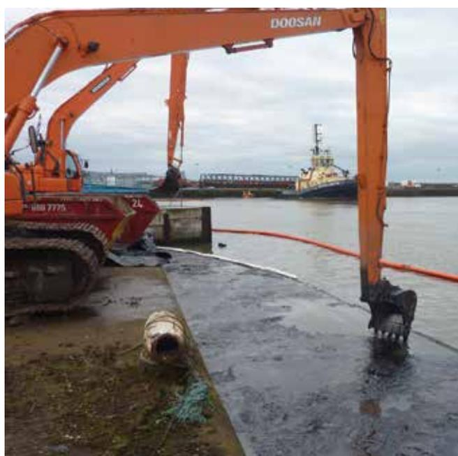
▲ Рис. 5: Строительные машины, применяемые для сбора нефти на территории порта. В данном случае температура воды была ниже температуры застывания нефти, в результате чего нефть приобрела полутвердое состояние, исключающее применение скиммеров.
