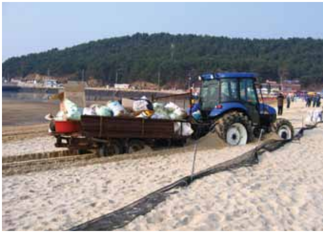
▲ الشكل رقم 39: يمكن أن تغرز العربات في الركائز الناعمة. وقد يسبب هذا المزيد من الأضرار واختلاط النفط بالتربة النظيفة.
