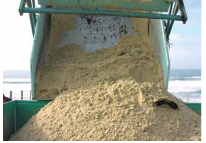
▲ الشكل رقم 7: أدى التجميع مباشرة باستخدام الماكينات الثقيلة إلى نسب عالية من المادة النظيفة وتركيزات قليلة للغاية من النفط في النفايات.
