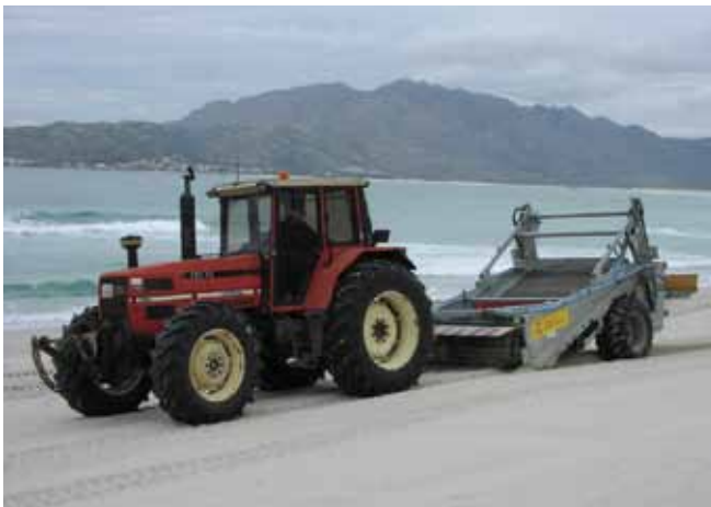
الشكل رقم 26: آلة لتنظيف الشاطئ يجرها جرّار تستخدم لجمع كتل القطران.
