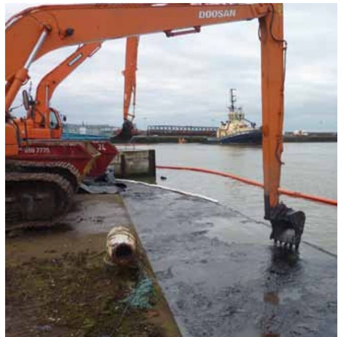
الشكل رقم 5: ماكينات الهندسة المدنية تستخدم لاستعادة النفط من منطقة ميناء. في هذا الموقف، كانت درجة حرارة المياه أقل من نقطة انصباب النفط، مما أدى إلى تحول النفط إلى الحالة نصف-صلبة، وألغى إمكانية استخدام أجهزة الكشط.
