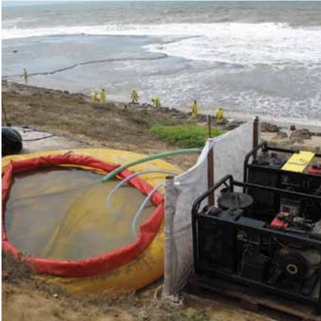
الشكل رقم 22: عملية تنظيف نتوء صخري بالضغط في موقع بعيد. تم ضخ مياه البحر إلى خزّان للتخزين المؤقت لتستخدمها آلات الضغط العالي المجاورة.
