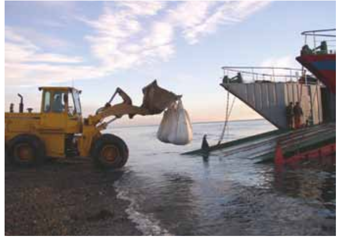
▲ الشكل رقم 11: يتم تجميع الأكياس الأصغر حجمًا من النفايات الملوثة بالنفط في "أكياس كبيرة" بسعة 1 طن، تنقل إلى زورق إنزال لإزالتها من شاطئ منزول.
