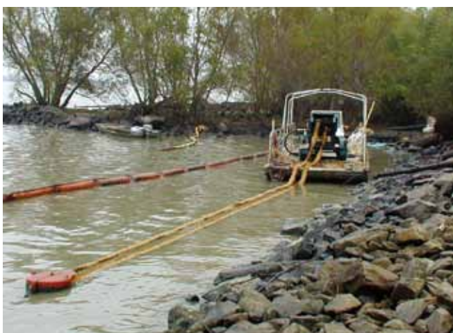
▲ ▶ 图 6 和图 7：横向和纵向的亲油性绳式撇浮装置。交织在一起的吸油环形成一条漂浮在水面上的连续拖把，油类将附着在这条拖把上。滚子将这条拖把拉回时，拖把上的油类便会被挤到一个储放罐中。绳式拖把撇浮装置对于从残骸、冰块及其他障碍物之间回收油类很有用。
