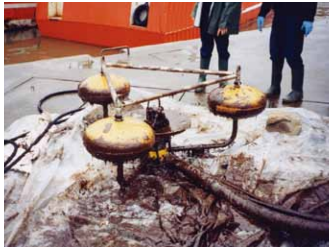
▲ 图 37：回收重质油类后被捞到岸上的导流坝撇浮装置。遭散后，应对设备进行清洗和大修，以备将来使用。
