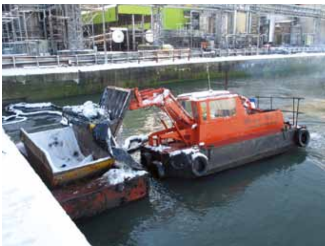
▲ 图 35：自力推进型船，通常用于回收港口中的残骸。在该图中，由于温度低且油类的倾点很高，油类变成半固态，因此需要用勺和抓斗将油类回收到漂浮的槽车中。
