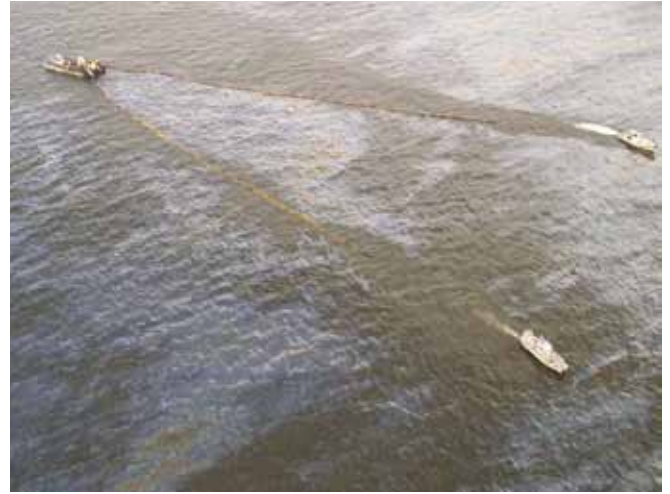
▲ 图 30：一艘与栅栏一起部署的带式撇浮船，由拖拽船以 V 字形拖拽。
