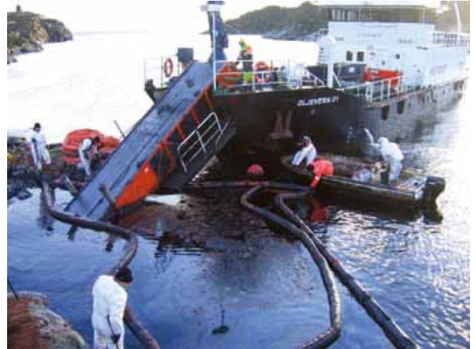
▲ 图 15: 大型回收船上的一个带式撇浮装置。这条用筛网制成的带子允许水穿过筛网排放出去, 并可促使油类粘着。油类将被提到船上并被刮到储放容器中。
