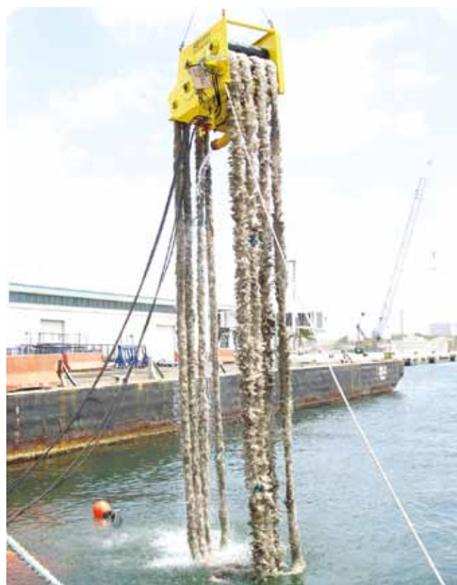
▲ 图 5：自由漂浮的刷式撇浮装置。油类附着在转动的成组刷子上，并从水面上被提起。用一个梳子将油类从刷子上清除到存储容器中。刷子背后的推进装置将浮油推向撇浮装置以提高遇油率和吞吐量（图片由 Lamor 惠供）。
