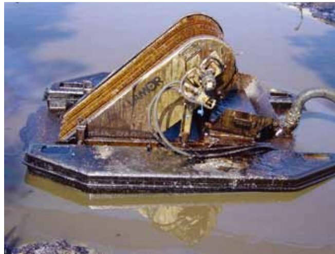
▲ 图 5：自由漂浮的刷式撇浮装置。油类附着在转动的成组刷子上，并从水面上被提起。用一个梳子将油类从刷子上清除到存储容器中。刷子背后的推进装置将浮油推向撇浮装置以提高遇油率和吞吐量（图片由 Lamor 惠供）。
