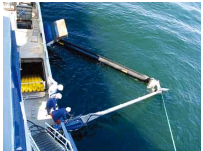
▲ 图 32：一个内置式单船回收系统。存放在舱室中船一侧的栅栏用船上的吊车通过一个开口进行部署。此开口还使得附连水能够通过船载撇浮装置进行回收，本图中的船载撇浮装置由一个传送带装置中的六组刷子构成（图片由 Lamor 惠供）。
