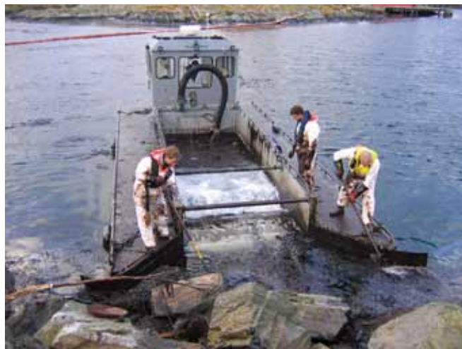
▲ 图 34：自力推进型导流坝撇浮装置正在有遮挡的多岩石入口处回收油类。由于船吃水浅，因此可以在靠近海岸的位置作业。操作员通过将油类移向导流坝开口来帮助回收。
