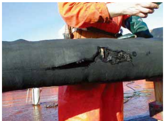
▲ 图 23: 因泵送高粘度油类而产生的内部压力过大,导致软管破裂(图片由 NOFO 惠供)。
