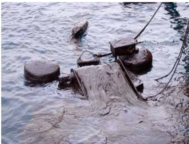
▲ 图 16: 增添了一个带子适配器以提升基本导流坝撇浮装置在高度乳化的燃油中的处理能力。这种油由于具有高粘度, 因而无法流向导流坝, 也无法从导流坝的边缘上方流过。而带齿的带子适配器则可以“抓住”油类, 从而提升了效率, 油类的内聚能则会导致其余油类“流”向撇浮装置(图片由 Ro-Clean Desmi/Danish Navy 惠供)。
