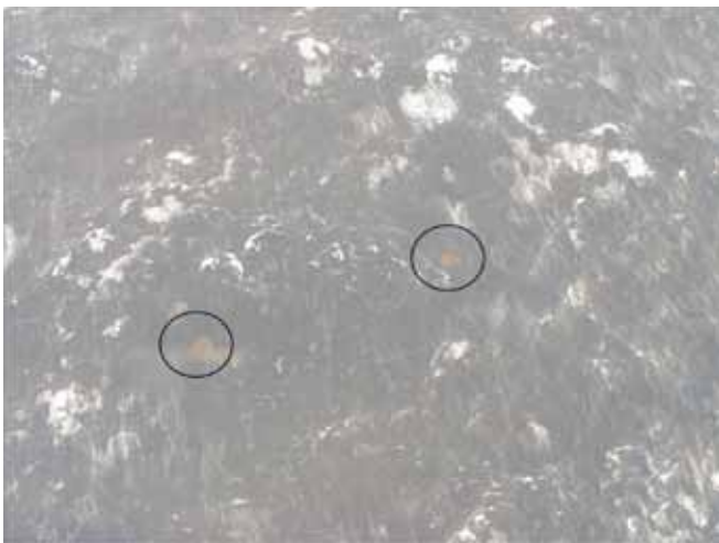
▲ 图 20：油类在海上漂流数周后，已经破裂并风化成直径为一米或更小的小油斑（图中圈出的位置），以及大面积分散的油块，从而导致总体效率大幅下降。应对工作进展到这个程度时，应遣散回收船，因为继续开展作业可能会被认为是徒劳。
