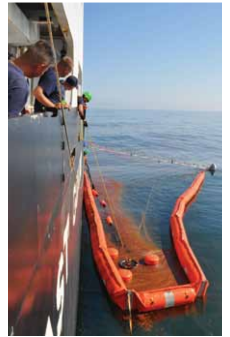
▲ الشكل رقم 29: حاجز تطويق طافٍ مسحوب في تشكيل على شكل حرف U مع جهاز كشط تم إنزاله من مركب الاستعادة الرئيسي.
