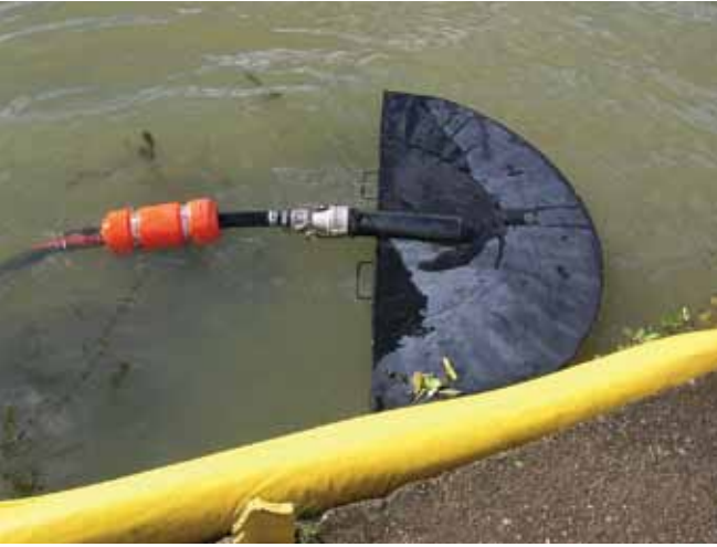
▲ الشكل رقم 11: جهاز كشط ذو حاجز متدلي ثابت متّصل بمضخة تفريغ. هناك عدد من الفتحات الصغيرة على حافة الرأس للسماح باستعادة النفط انتقائيًا. يستخدم في المياه الهادئة في وجود الحد الأدنى من حطام السفن (الصورة مهداة من "لامور").
