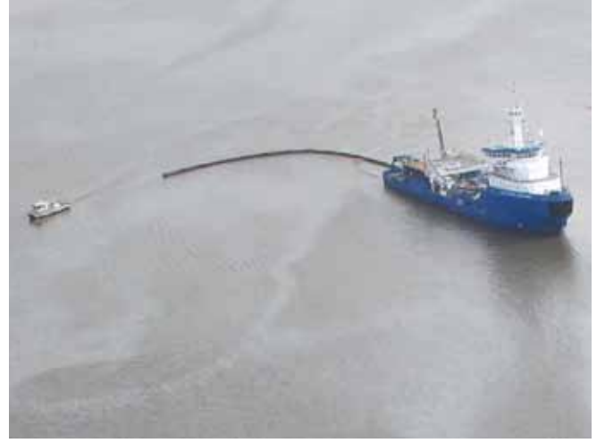
▲ الشكل رقم 29: حاجز تطويق طافٍ مسحوب في تشكيل على شكل حرف U مع جهاز كشط تم إنزاله من مركب الاستعادة الرئيسي.
