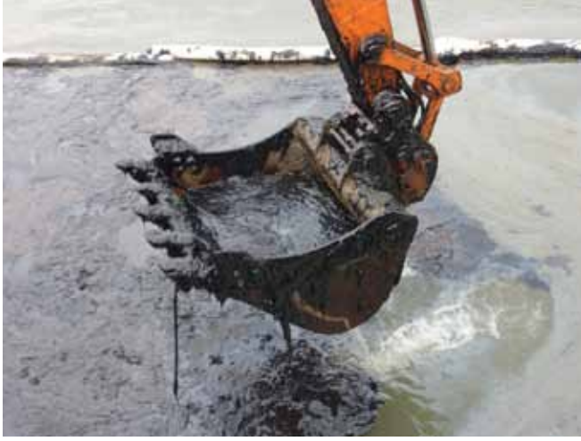
الشكل رقم 21: استخدام جهاز حفر لاستعادة نفث وقود عالي اللزوجة. تم رفع تركيز النفط المستعاد إلى الحد الأقصى من خلال إعطاء تعليمات لعامل التشغيل بالإسك بالذلو أعلى سطح المياه لفترة وجيزة، للسماح بتصريف المياه المحمّولة مع النفط. وقد قلل هذا من تكاليف التخلص في المراحل التالية على حساب كفاءة الاستعادة.
