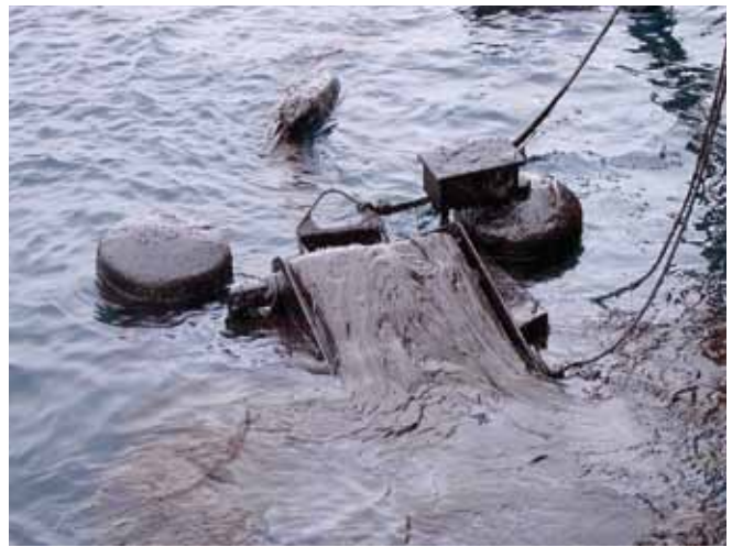
▲ الشكل رقم 16: وحدة موازنة سير أضيفت لتحسين قدرة جهاز الكشط الأساسي المزود بحاجز غاطس في وجود نفط وقود مكوناً مستحلباً لدرجة كبيرة. حالت لزوجة النفط العالية دون تدفقه إلى أعلى متجاوزاً شفير الحاجز الغاطس. وبدلاً من ذلك، قامت وحدة موازنة مسننة للسير "بالإمساك" بالنفط مما يحسن من الكفاءة، وتسببت طاقة الالتصاق في النفط في "تدفق" النفط المتبقي في اتجاه جهاز الكشط (الصورة مهداة من Ro-Clean Desmi/البحرية الدنماركية).
