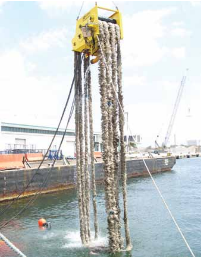
▲ الشكل رقم 5: جهاز كشط ذو فرشاة طافية حرة. يلتصق النفط بمجموعات الفرش الدوّارة ويتم رفعه من سطح الماء. ينزع النفط من الفرشاة عن طريق مشط ليوضع في مكان التخزين. تقوم دافعة مثبتة خلف الفرشاة بسحب النفط الطافي في اتجاه جهاز الكشط لتحسين معدل الالتقاء والإنتاجية (الصورة مهداة من "لامور").
