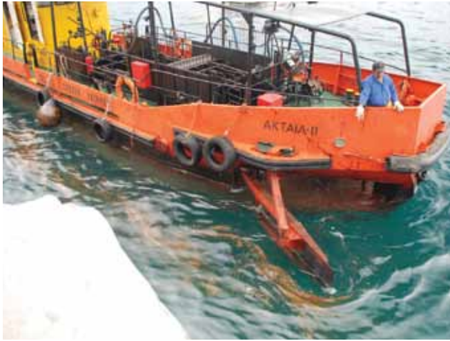
الشكل رقم 1: جهاز كشط ذو حاجز غاطس ذاتي الدفع للاستخدام في الموانئ وفي المياه القريبة من الشاطئ. يتم فتح أبواب المقدمة لتحسين عرض النطاق والسماح بدخول النفط الطافي. النفط المستعاد يتم ضخه إلى خزان داخلي.
