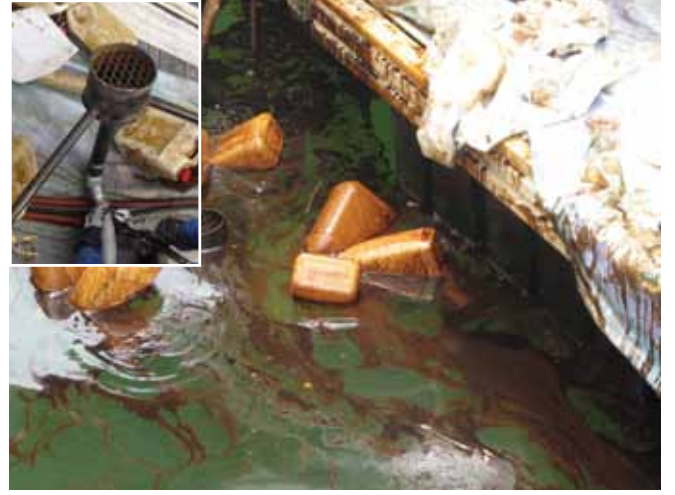
▲ الشكل رقم 14: جهاز كشط مرتجل ذو حاجز غاطس تم إنشاؤه من زجاجات بلاستيكية وقطع معدنية متصلة بمضخة تفريغ. يتيح هذه الجهاز صورة بدائية من الاستعادة يمكن ضبطها من خلال نزع أو إضافة الزجاجات.
