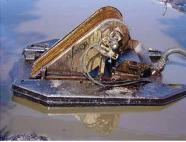
▲ الشكل رقم 5: جهاز كشط ذو فرشاة طافية حرة. يلتصق النفط بمجموعات الفرش الدوّارة ويتم رفعه من سطح الماء. ينزع النفط من الفرشاة عن طريق مشط ليوضع في مكان التخزين. تقوم دافعة مثبتة خلف الفرشاة بسحب النفط الطافي في اتجاه جهاز الكشط لتحسين معدل الالتقاء والإنتاجية (الصورة مهداة من "لامور").
