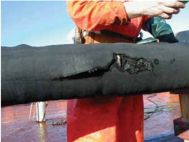
الشكل رقم 23: خرطوم منفجر نتيجة للضغط الداخلي الزائد الناشئ من ضخ وقود عالي اللزوجة (الصورة مهداة من NOFO).
