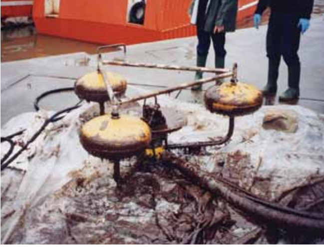
▲ الشكل رقم 37: جهاز كشط ذو حاجز غاطس تمت إعادته للساحل بعد استعادة نפט ثقيل. بعد إنهاء الاستخدام، يجب تنظيف المعدات وإجراء الصيانة الشاملة لها استعداداً للاستخدام في المستقبل.
