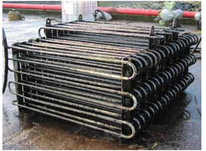
الشكل رقم 27: ▶ ملف تسخين محمول يستخدم للمساعدة في تصريف النفط اللزج من مراكب الاستعادة إلى الشاطئ.
