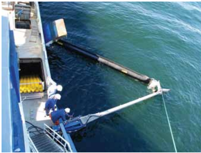
▲ الشكل رقم 32: نظام استعادة مصمم داخلياً في سفينة واحدة. حاجز التطويق الطافي المخزن في حجرة على جانب المركب يتم إخراجها للاستخدام من خلال فتحة بواسطة ونش موجود على سطح المركب. كما تتيح الفتحة استعادة النفط المحتجز من خلال جهاز كشط مثبت على المركب، وهو يتكون هنا من ست مجموعات من الفرش في ترتيب يشبه ناقل الحركة.
