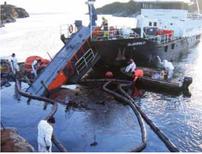
▲ الشكل رقم 15: جهاز كشط يعمل بالسير على مركب استعادة كبير. يتيح السير، المصنوع من شبكة، تصريف المياه من خلال الشبكة ويشجع التصاق النفط. يتم رفع النفط على سطح المركب ويتم كشطه إلى مكان التخزين.
