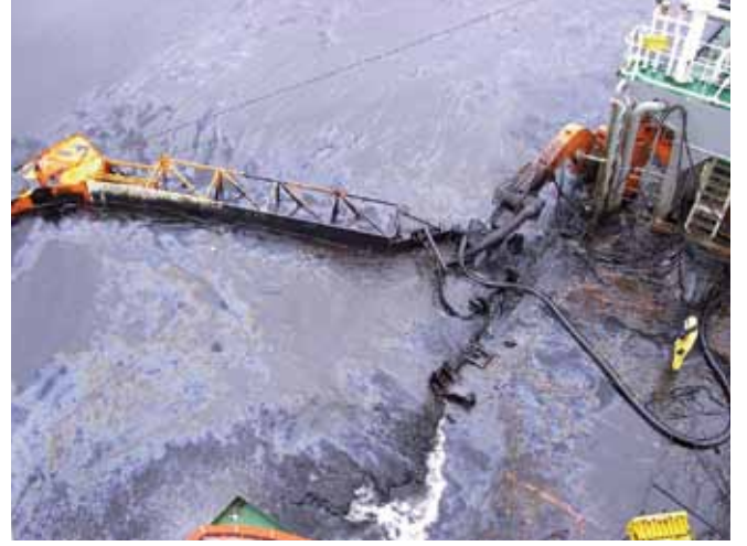
▲ الشكل رقم 33: ذراع مسح صلب مرتبط بونش هيدروليكي بمركب الاستعادة. انخفاض المسافة الرأسية بين سطح الماء وجسم المركب والموج المرتفع الذي يواجهه المركب جعلت الظروف على السطح خطيرة بالنسبة لطاقم العمل في المركب (الصورة مهداة من WSA كوكسهافن).
