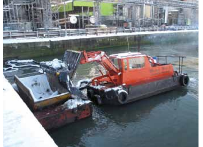
▲ الشكل رقم 35: مركب ذو دفع ذاتي، يستخدم عادة لاستعادة حطام السفن في الميناء. هنا، تسبب انخفاض درجات الحرارة ونقطة الانصهار المرتفعة نسبياً في تحول النفط إلى نصف صلب، مما يستلزم الاستعادة من خلال المجرفة والماصات إلى سلة طافية.
