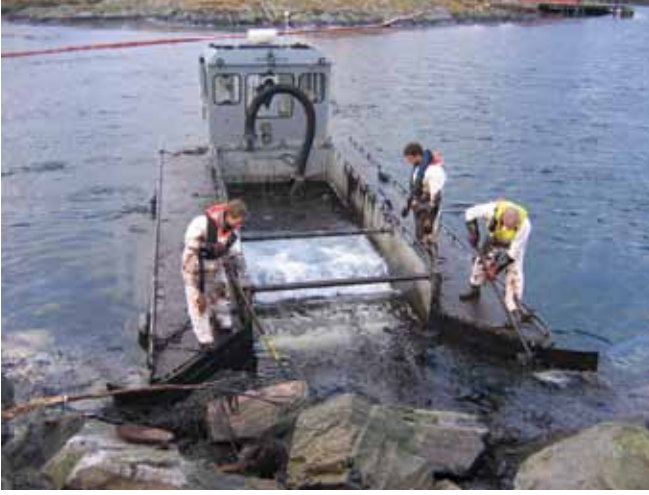
▲ الشكل رقم 34: جهاز كشف ذو حاجز غاطس يقوم باستعادة النفط في مدخل صخري محمي. يتيح الغاطس الضحل للمركب العمل بالقرب من الشاطئ. يساعد عمال التشغيل بتحريك النفط في اتجاه فوهة الحاجز الغاطس.
