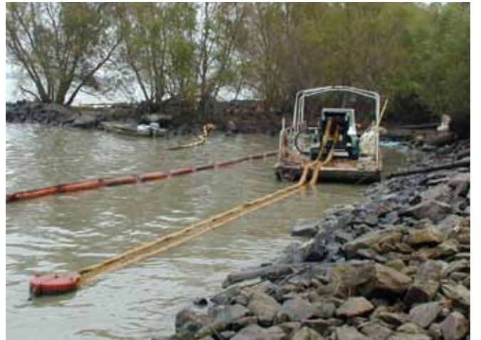
▲ الشكل رقم 6 والشكل رقم 7: أجهزة كشط أفقية ورأسية تعمل بالحبال الأليف للزيت. حلقات ماصة منسوجة تكوّن ممسحة متصلة تطفو على السطح ويلتصق بها النفط. تُسحب الممسحة إلى بكرة ويتم عصر النفط إلى خزّان. تعتبر أجهزة الكشط ذات الممسحة المعلقة بحبل مفيدة لاستعادة النفط من بين حطام السفن، والجليد والعوائق الأخرى.
