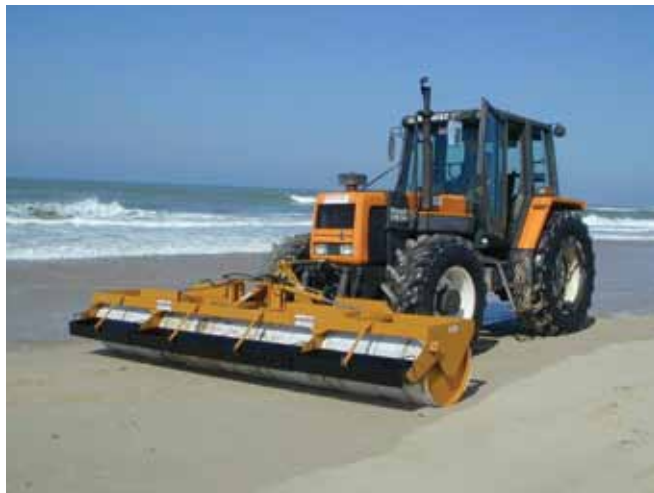
الشكل رقم 36: جهاز كشط أليف للزيت محمّل على جرّار، يستخدم لتجميع كتل القطران الجديدة على شاطئ رملي كثيف الرمال (الصورة مهداة من Le Floch (Dépollution).
