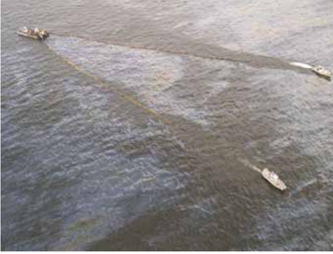
▲ الشكل رقم 30: مركب كشط مجهز بسير يتم مع حاجز تطويق طافٍ ومركب سحب في تشكيل على شكل حرف V.
