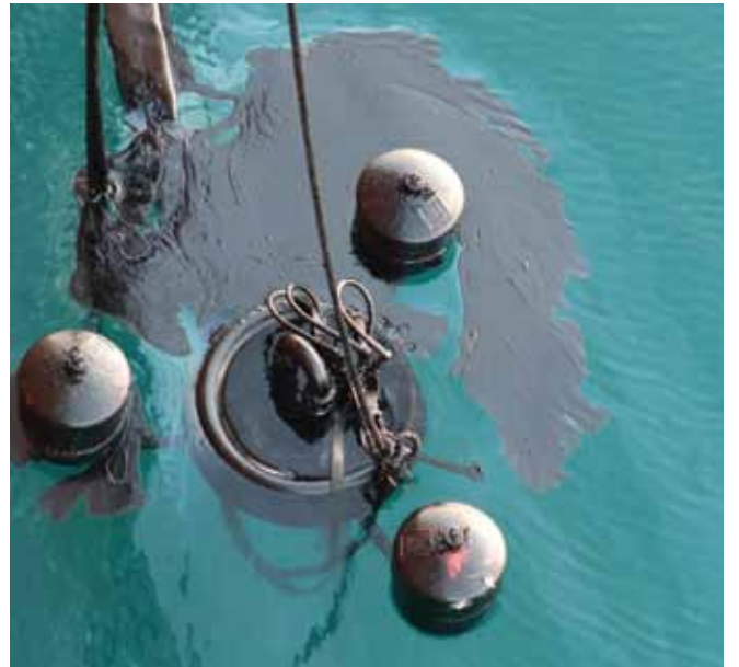
▲ الشكل رقم 12 والشكل رقم 13: جهاز كشط ذو حاجز غاطس يستعيد النفط انتقائيًا من أعلى الحاجز الغاطس المركزي الموجود أسفل سطح بقعة النفط مباشرة باستخدام قوة الجاذبية إلى داخل صهريج حيث يتم ضخه إلى مكان التخزين.
