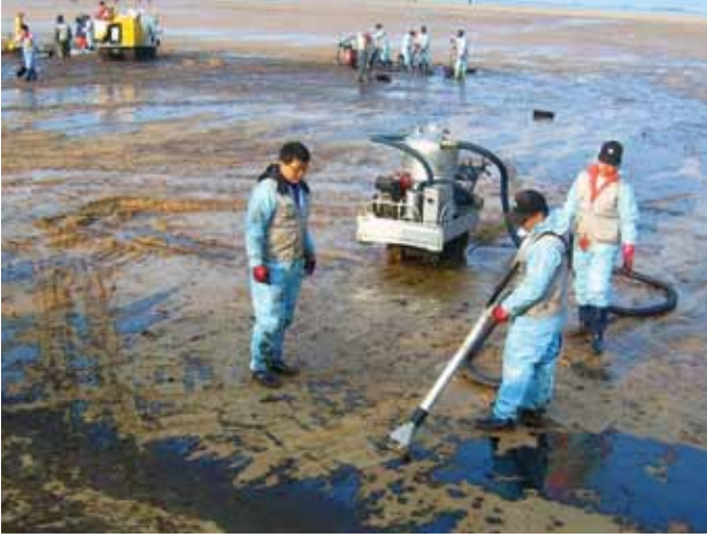
▲ الشكل رقم 9: يمكن لأنظمة التفريغ المحمولة أن تسهّل استعادة النفط من الشواطئ الرملية والسواحل الصخرية. يتيح هذا النظام المدمج العمل في المناطق التي يصعب الوصول إليها، وذلك رغم محدودية حيز التخزين.
