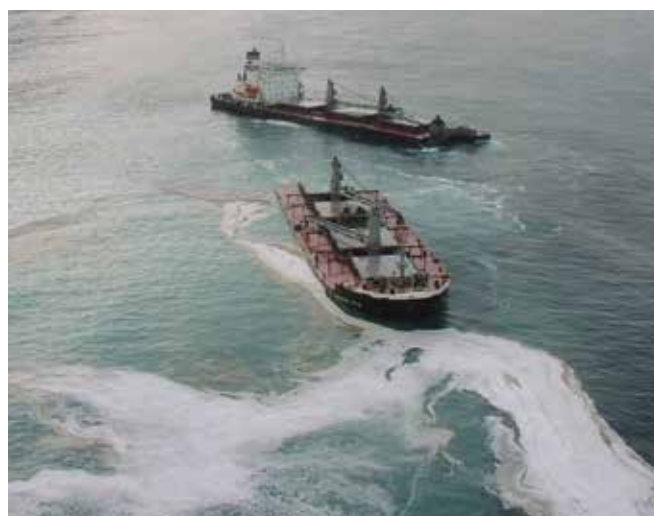
▲ Рис. 13: Разлив тяжелой фракции нефти в результате аварии сухогруза. Груз перемешался с нефтью, что затруднило реалистичный расчет объема разлитой нефти.
