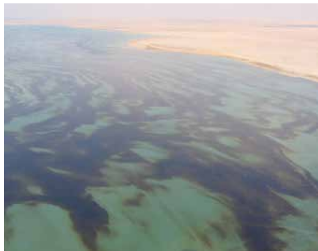
▲ Рис. 11: Очень крупные разорванные пятна тяжелой фракции нефти - обратите внимание на отсутствие блеска.
