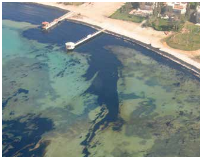
▲ Рис. 15: Тяжелое дизельное топливо, прибываемое к береговой линии. Бентоническая морская трава и донные скальные формации могут исказить результаты расчетов количества нефти.
