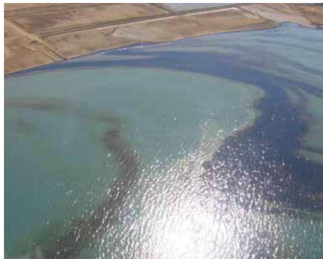
▲ Рис. 21: Отражение света от морской поверхности иногда может создавать трудности при проведении аэрофотосъемки; УФ-фильтры и поляризационные светофильтры могут быть полезны для повышения резкости изображения нефти.
