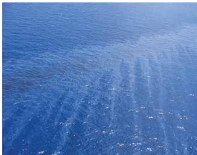
▲ Рис. 10: Полоса черной нефти наблюдается от левого к правому краю изображения. Ветер, дующий поперек нефти, отодвигает эту полосу от наблюдателя с образованием перпендикулярных полос с различным блеском.
