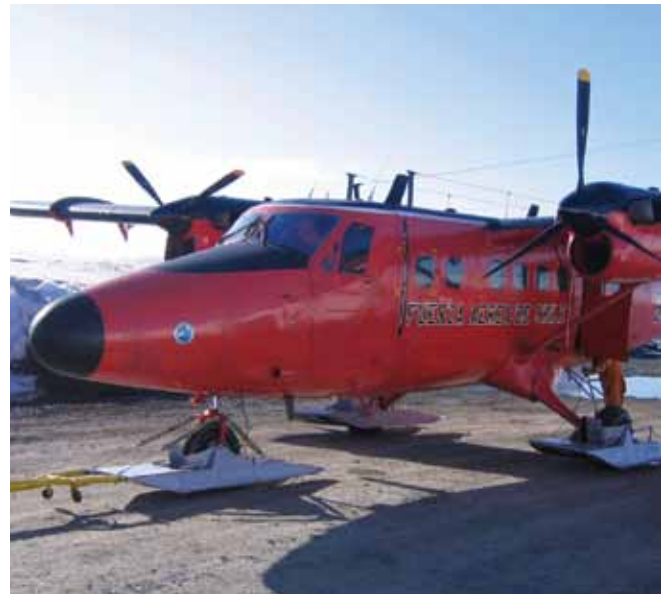
الشكل رقم 2: تعتبر الطائرات ذات المحركين والأجنحة الثابتة المرتفعة مثالية لمراقبة النفط في البحر. وقد يكون استخدام الطائرات المروحية مفضلاً أكثر في المراقبة بالقرب من الساحل نظرًا لقدراتها الزائدة على المناورة وسرعاتها المنخفضة.
