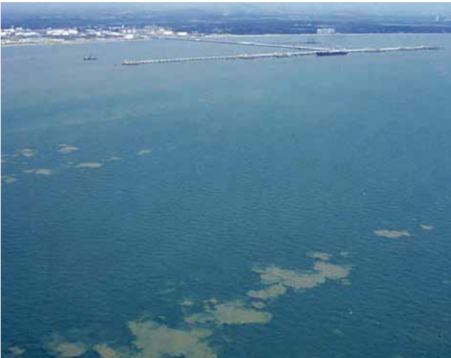
▲ الشكل رقم 17: أعمدة الرواسب التي تحركها التيارات المائية في المناطق الضحلة تشبه بقعًا من مستحلب النفط الخام الخفيف.
