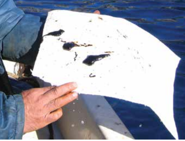
▲ Şekil 6: Temiz bir emici yastıkla su yüzeyindeki petrol tabakasının yakalanması.
