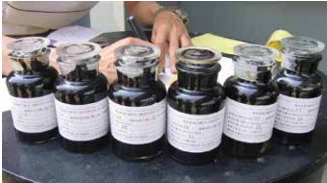
▲ Şekil 11: Geniş ağızlı cam kavanozlarda çok iyi etiketlenmiş gemi yakıtı numuneleri (bu durumda tek bir tanktan alınan numuneler bölünmüştür).
