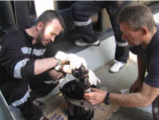
▲ Şekil 4: Bir enkazın güvertesinde bir gemi yakıtı kaynağından petrol numunesinin boşaltılarak aktarılması.
