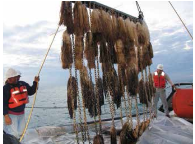
▲ Şekil 3: Gelgitte suyun çekildiği seviyenin altından numune alma için emici maddelerin kullanılması. Emici maddenin tutturulduğu çerçeve, deniz yatağı boyunca yedekte çekilmektedir. Yukarı kaldırıldığında emici madde üzerinde petrolün mevcudiyeti suyun içine batmış olan petrolün coğrafi boyutunun tespit edilmesine olanak sağlamaktadır.
