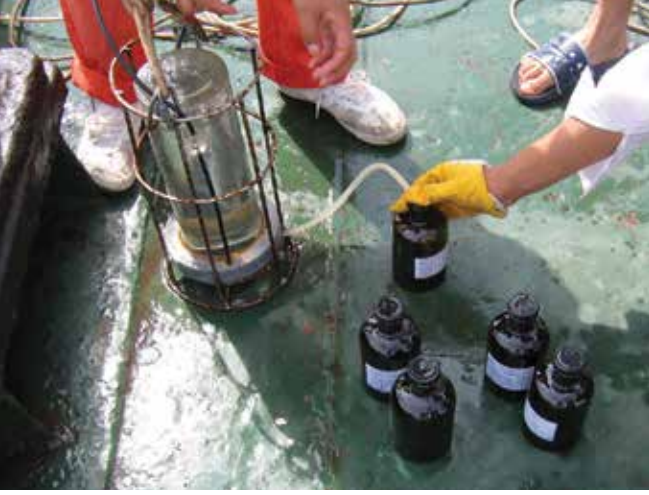
▲ Şekil 8: Kazara dökülmüş petrolden numune almak için, su numunelerinin numune toplama cihazından cam şişelerin içerisine boşaltılarak aktarılması.
