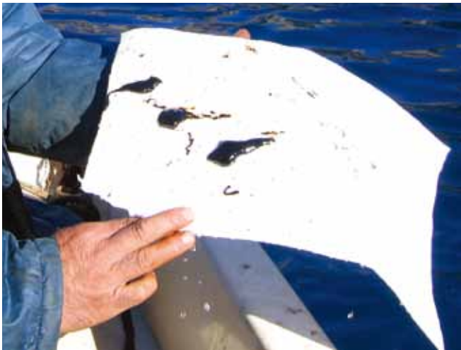
▲ 图 6：使用清洁的吸油垫捕获漂浮油。
