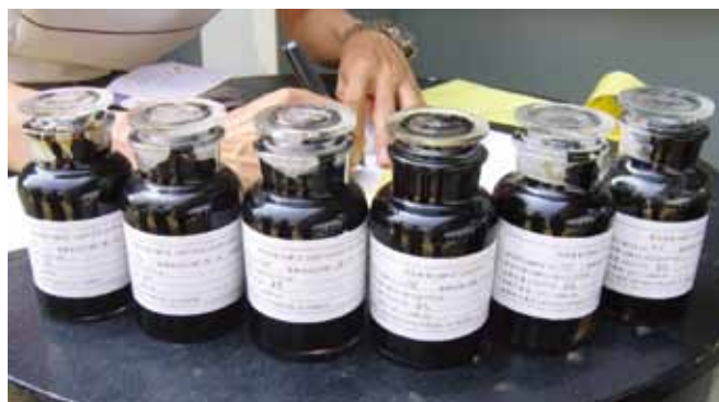
▲ 图 11：进行了适当标贴的广口玻璃瓶中的燃油舱样本（在本例中为来自单个油箱的拆分样本）。
