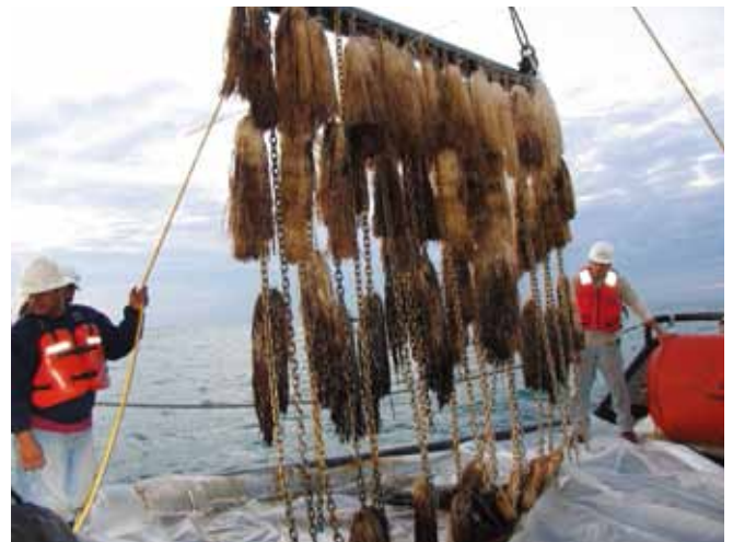
▲ 图 3：使用吸油物进行潮下取样。配有吸油物的框架在海床上拖行。收起时在吸油物上是否存在油类可帮助确定沉底油类的地理分布范围。
