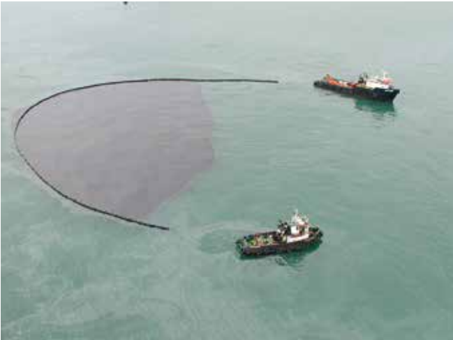
▲ Şekil 5: Petrol başarılı bir şekilde kontrol altına alınmış olmasına rağmen, petrolün yüzey suyundan toplanması ve geçici olarak depolanması için araçlar olmaksızın bu çabalar boşuna olabilmektedir.
