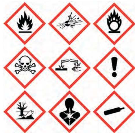
▲ 그림 7: HNS 표시를 위한 GHS 그림문자. 왼쪽에서부터 오른쪽으로 가연성, 폭발성, 산화성, 급성 독성, 부식성, 유해성/자극성, 환경 유독성, 발암물질/민감성, 압축가스. 이들은 국가별 또는 지역별 표시로 대체되기도 한다.
