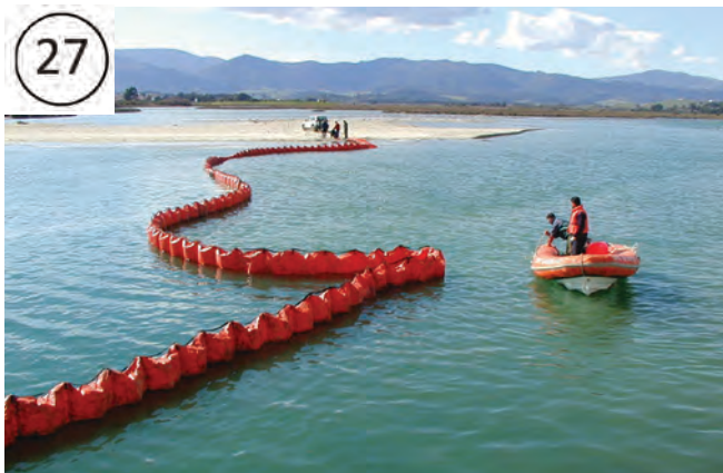
▲ 그림 5 : 오일펜스 전장지역. 오일펜스는 부유기름을 해안에서 접근하기 좋은 포집지점으로 이동시키기 위해 전장된다.
