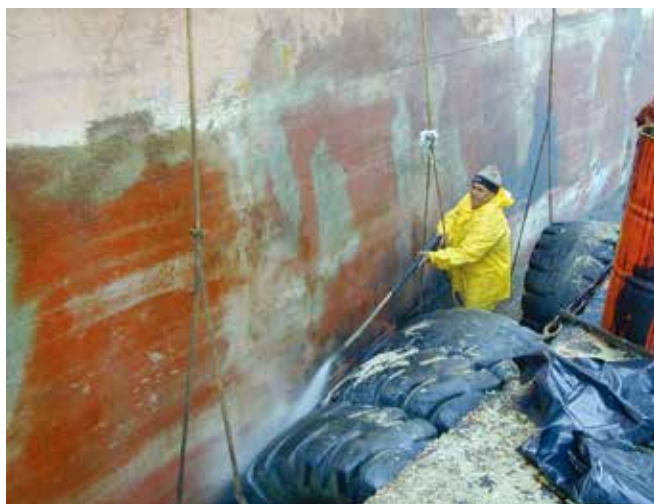
▲ 図4: 洗浄専門の請負業者は通常大型の一般商船を洗浄するために雇われる。
