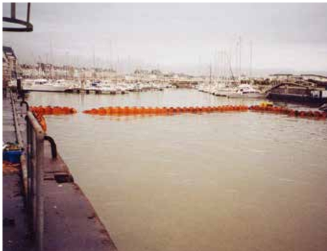
▲ 図2:船舶の出入りによってオイルフェンスが損傷すると、マリーナの入口に展張されたオイルフェンスの効果が損なわれることがある。
