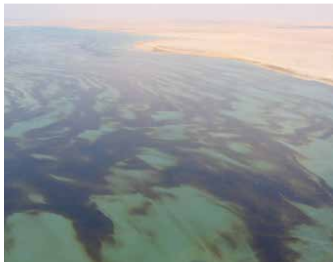
▲ 図11：C重油の非常に大きな断続した油膜—キラツキが見られないことに注意。
