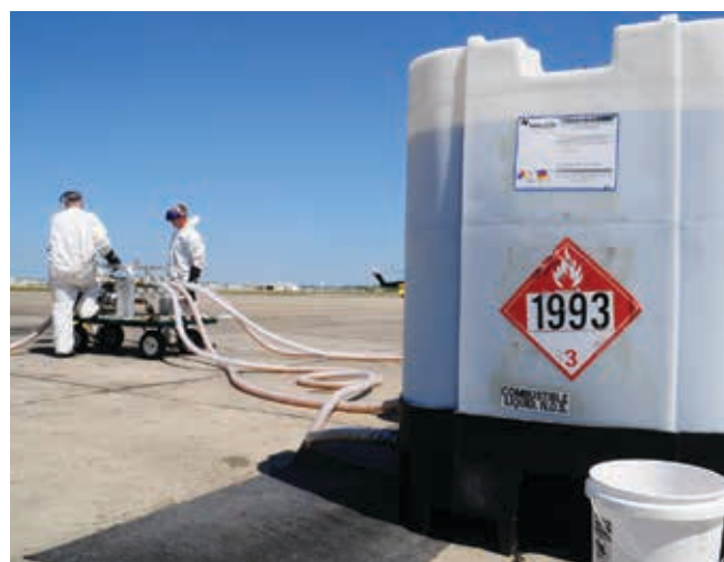
▲ Figura 12: el uso de recipientes intermedios para graneles (RIG) de 1 \text{ m}^3 simplifica el almacenamiento y manipulación del dispersante. (Imagen gentileza de USCG).
