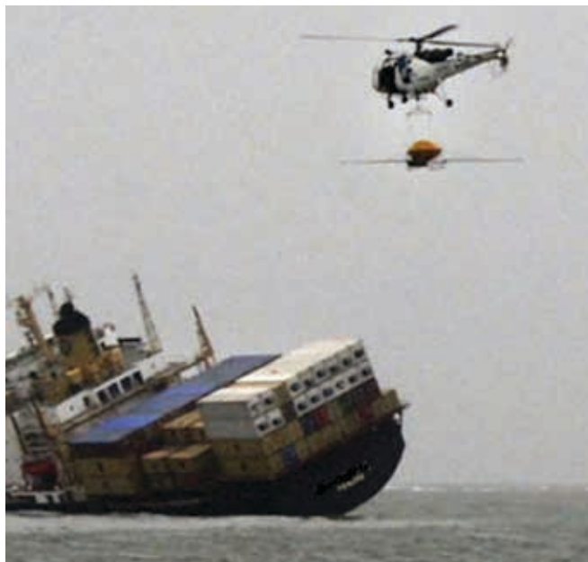
▲ Figura 11: un helicóptero, con un sistema de rociado bajo el chasis, aproximándose a un derrame fresco de fueloil. Para que resulte eficaz, sería necesario realizar la aplicación desde una altitud más baja. (Imagen gentileza de Guardacostas de la India).
