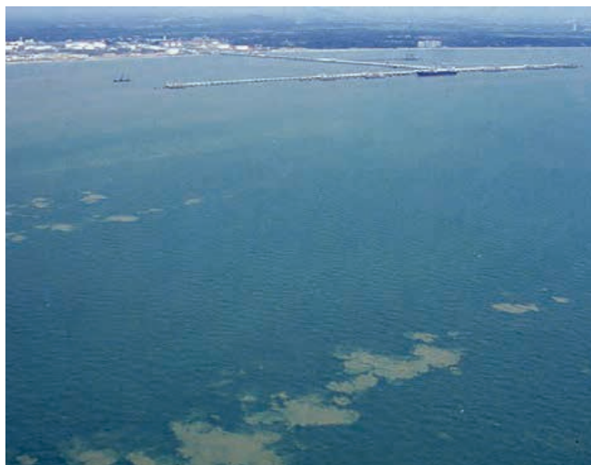
▲ Figura 17: penachos de sedimentos afectados por corrientes en áreas poco profundas, que simulan manchas de petróleo crudo emulsionado ligero.
