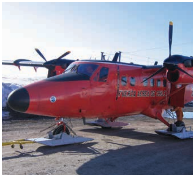
▲ Figura 2: las aeronaves bimotor de ala fija con las alas situadas en una posición elevada representan plataformas ideales para la observación aérea de hidrocarburos en el mar. Los helicópteros podrían ser preferibles para una observación más cercana de la costa debido a su mayor capacidad de maniobra y a sus menores velocidades.
