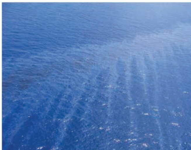
▲ Figura 10: se observa una banda de hidrocarburos negros de izquierda a derecha en la imagen. El viento, que sopla a través de los hidrocarburos, empuja esta banda lejos del observador, lo que genera hileras con brillos diferentes.
