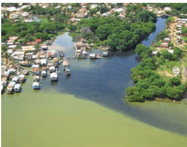
▲ Figura 18: escorrentías de agua dulce procedentes de un riachuelo que se mezcla con agua salobre turbia, dando la apariencia de una contaminación local significativa.
