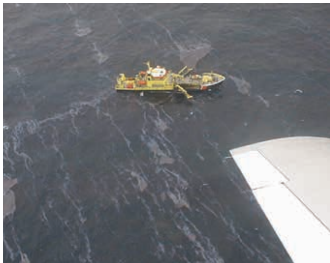
▲ Figura 20: resulta útil incluir buques u otros puntos de referencia en una fotografía para proporcionar una idea de la escala de la contaminación.
