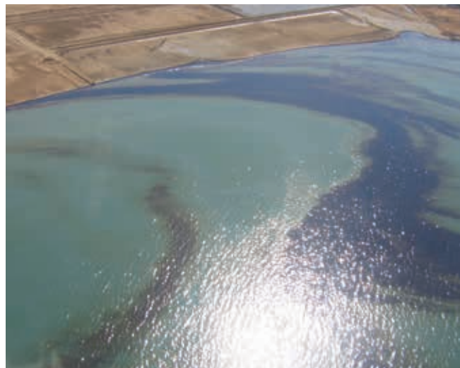
▲ Figura 21: a veces, el reflejo de la luz en el mar puede plantear un problema al tomar fotografías aéreas; los filtros de UV y de polarización pueden ayudar a perfeccionar la definición visual de los hidrocarburos.
