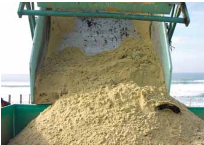
▲ 图 7：使用重型机械设备直接回收时，废物中干净物质所占的比例很高，油类含量非常低。
