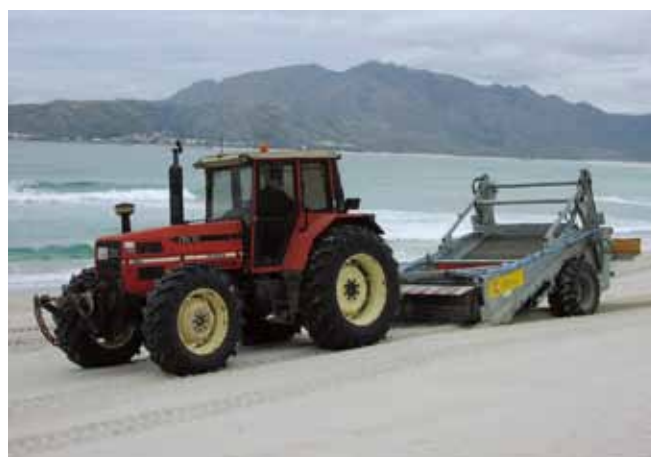
▲ 图 26：一台由拖拉机牵引的海滩清理机正在回收油块。
