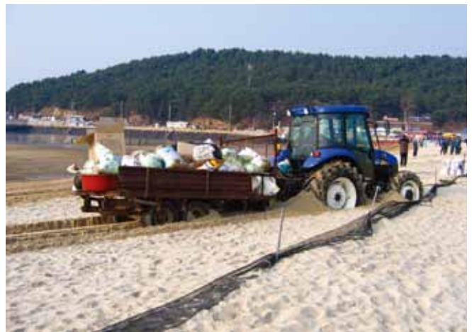
▲ 图 39: 装了货的车辆可能会陷入柔软底物中。这可能会造成额外的破坏，使油类与原本干净的底物混在一起。
