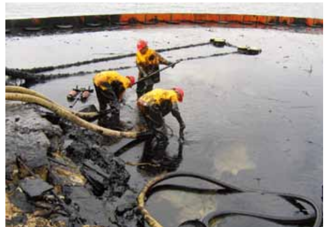
▲ 图 3：使用绳式拖把撇浮装置和真空泵从海岸线回收液态的大片油类。
