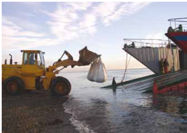
▲ 图 11: 较小袋沾油废物在整合成容量为一吨的“集装袋”后, 被运到一个登陆艇上面, 以便从隔离的海岸线上清除。
