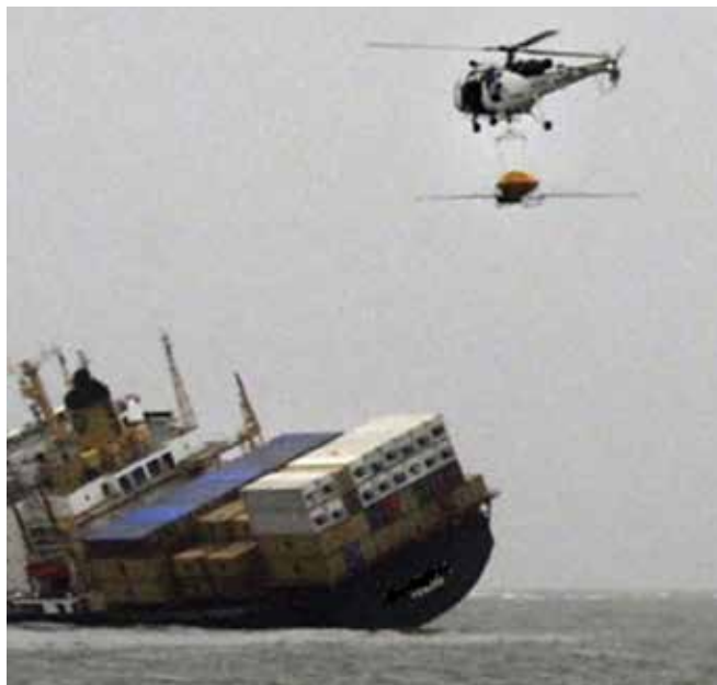
▲ Рис. 11: Вертолет с закрепленной снизу строповкой системой распыления на подходе к свежему разливу топливной нефти. Для эффективного действия потребуются нанесение с более низкой высоты (любезно предоставлено Indian Coastguard).
