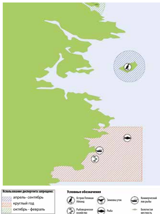
▲ Рис. 17: Карты экологической уязвимости часто включаются в планы мероприятий по ликвидации аварийных ситуаций для указания районов и временных рамок возможного использования диспергентов. В данном примере использование диспергентов запрещено на красном участке из-за круглогодичного коммерческого лова рыбы, но проводится по предварительному разрешению на сезонной основе для очистки от нефти акватории вокруг птичьей колонии на острове Пеликан Айланд. В особых случаях может допускаться использование диспергентов на мелководье вблизи побережья, например, для защиты мангровых зарослей или болот, которые чрезвычайно чувствительны к воздействию нефтяных скоплений.
