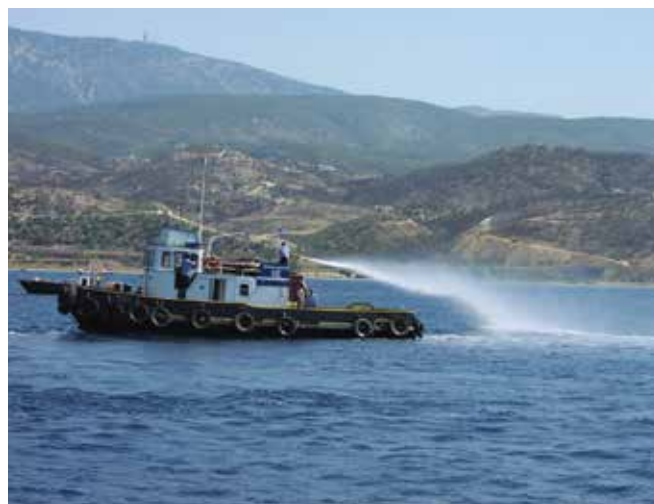
▲ Рис. 8: Нанесение диспергента с помощью гидромониторов на буксире. Показано неравномерное распространение диспергента и воздействие ветра.
