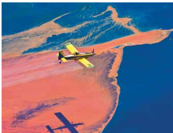
▲ Рис. 9: Самолет сельскохозяйственной авиации проводит распыление из подкрыльевой штанги с распыляющими насадками на разлив сырой нефти с морской платформы (любезно предоставлено Mark Hamilton Photography).
