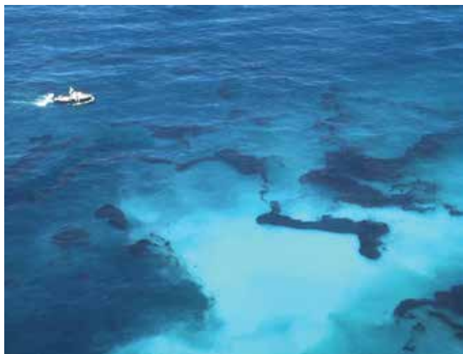
▲ Рис. 5: Неэффективная обработка тяжелого дизельного топлива с помощью диспергентов характеризуется белым шлейфом в воде. Нефть остается не затронутой.
