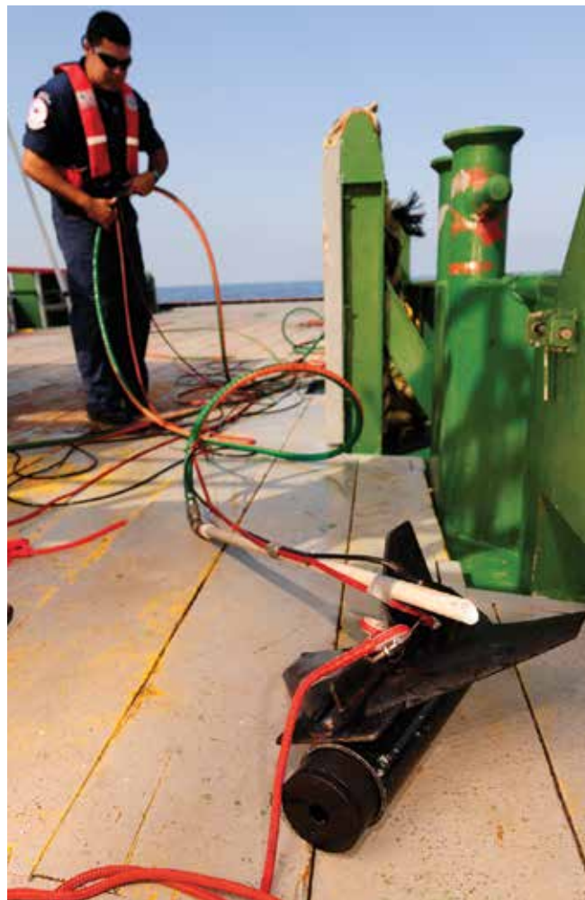
▲ Рис. 13: Подготовка буксируемого флуорометра для измерения эффективности диспергента на море (любезно предоставлено Береговая охрана США).
