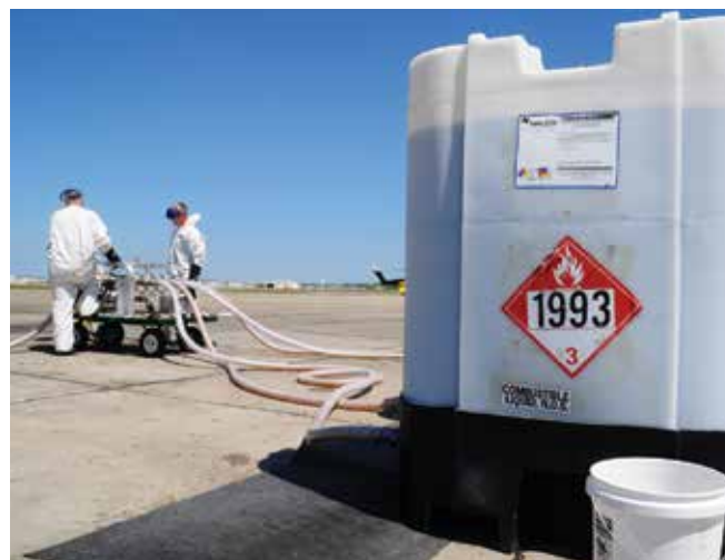
▲ Рис. 12: Применение контейнеров средней вместимости объемом в 1 м 3 для насыпных грузов (IBC) удобно для хранения и забора диспергента (любезно предоставлено Береговая охрана США).
