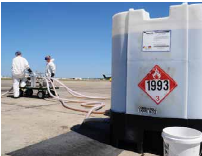
▲ الشكل رقم 12: تتيح استخدام حاويات متوسطة للمواد السائبة (IBCs) بسعة 1 متر 3 تخزين المشتتات وتداولها بسهولة. (الصورة إهداء من USCG).
