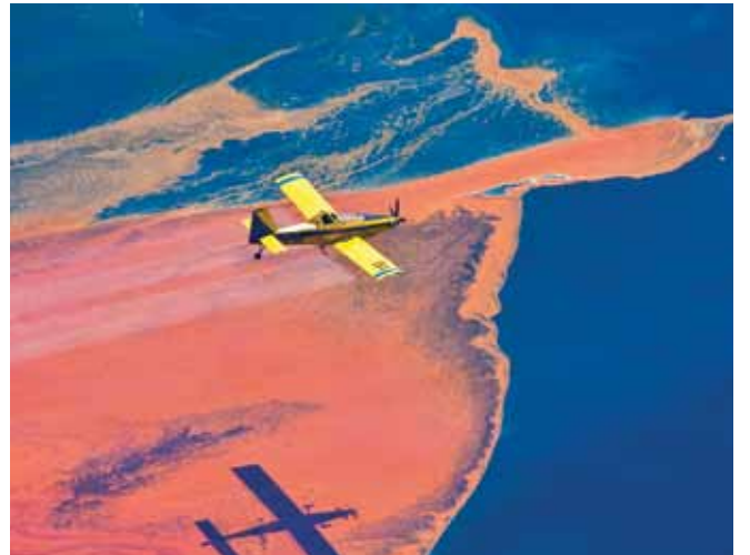
▲ الشكل رقم 9: طائرة من طراز Air Tractor من حاجز مدفع رش تحت الجناح على نفط خام مسكوب من منصة بحرية. (الصورة مهداة من مؤسسة مارك هاميلتون للصور الفوتوغرافية).
