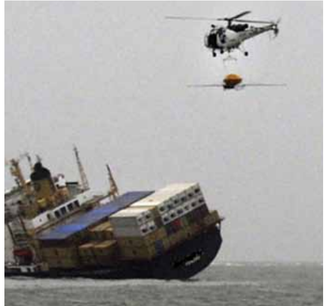
▲ الشكل رقم 11: طائرة مروحية، بنظام رش ذي متدلى من الأسفل، تقترب من انسكاب جديد من نפט وقود. لكي يكون الاستخدام فعالاً، لابد من الاستخدام على ارتفاعات منخفضة. (الصورة مهداة من حرس السواحل الهندي).
