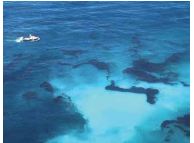
الشكل رقم 5: المعالجة غير الفعالة لنطف الوقود الثقيل بالمشتتات يميزها وجود بقعة بيضاء في المياه. يبقى النفط دون أن يتأثر.
