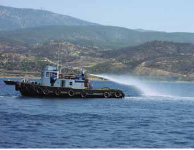
▲ الشكل رقم 8: استخدام المشتتات عن طريق أجهزة إطفاء الحرائق، وهي تبين انتشار غير متساوي للمشتت وتأثير الرياح.
