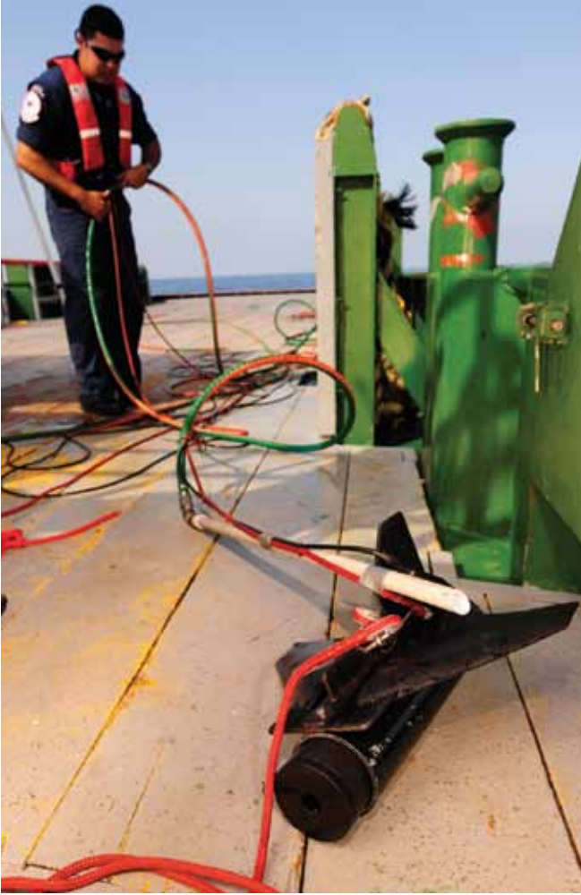
الشكل رقم 13: إعداد جهاز مسح لقياس الإشعاع الفلوري لقياس فعالية المشتتات في البحر. (الصورة إهداء من USCG).
