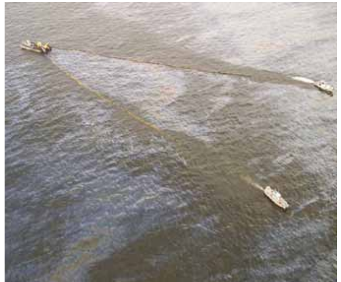
▲ 图 9: 两艘拖拽船以 V 形配置使用的帘式栅栏, 在顶点位置另有一艘浮油回收船。
