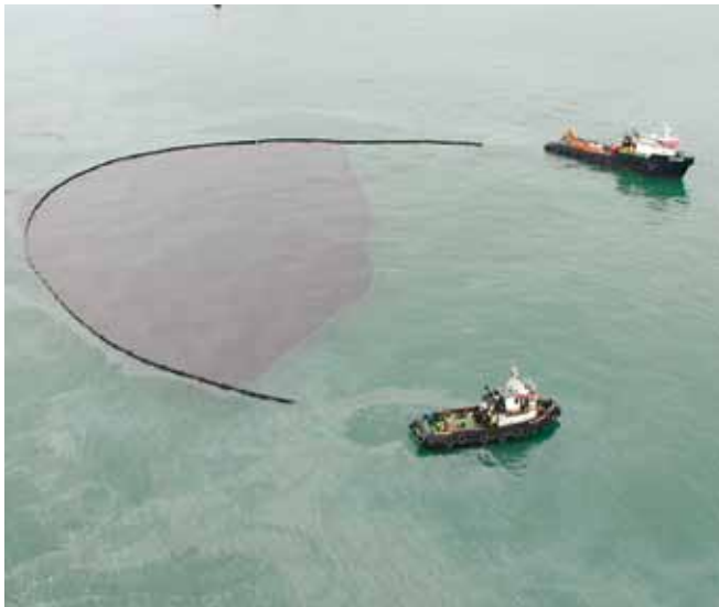
▲ 图 8: 为围堵某种重质原油而在两艘船之间以 U 形配置部署的充气式栅栏。回收这些油后, 此项作业便圆满成功。
