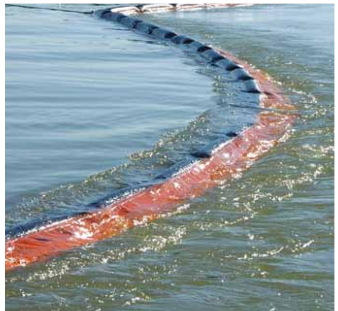
▲ 图 4: 强劲水流已导致栅栏平倒，从而使得裙摆下有油类流走。
