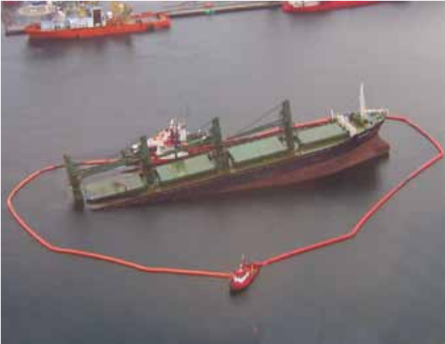
▲ 图 12: 充气式栅栏锚定在一艘已部分沉没的失事船周围, 以便围堵可能泄漏的任何船用燃油。
