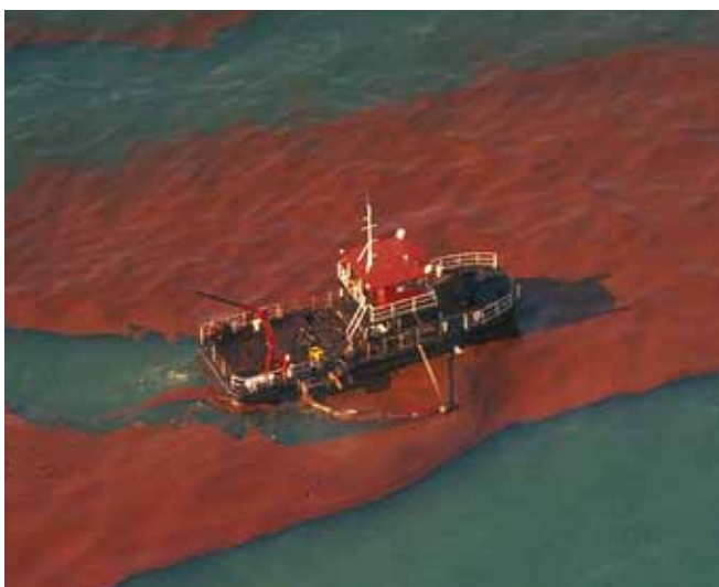
▲ 图 10: 单船回收系统, 采用从油类回收艇部署的较短帘式栅栏。图为正在回收严重乳化的原油。
