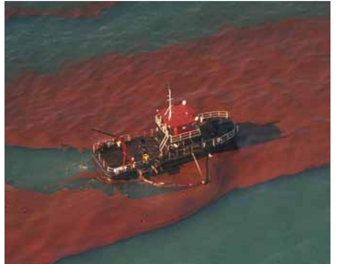
▲ الشكل رقم 10: نظام تجميع باستخدام سفينة واحدة يستخدم طول قصير من الحواجز الغلالية تم إنشاؤه عن طريق طوافه مخصصة لاستعادة النفط، في وسط نفط خام مكوّن لمستحلب بصورة كثيفة.
