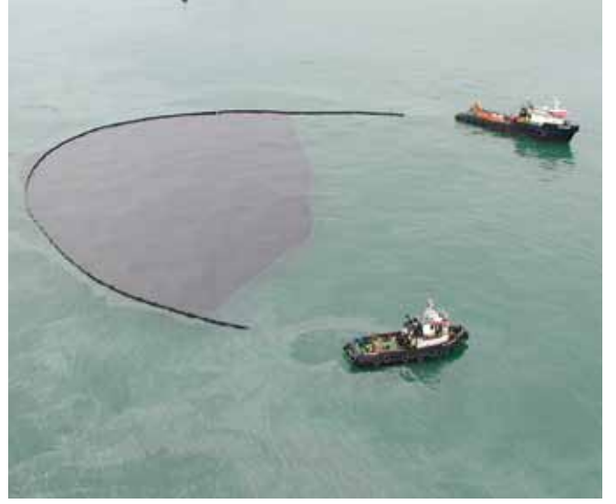
▲ الشكل رقم 8: حاجز تطويق طافٍ قابل للملء بالهواء موضوع في تشكيل بين مركبين على شكل حرف U لاحتواء نفط خام ثقيل ، سوف تعني استعادة النفط انتهاء العملية بنجاح.
