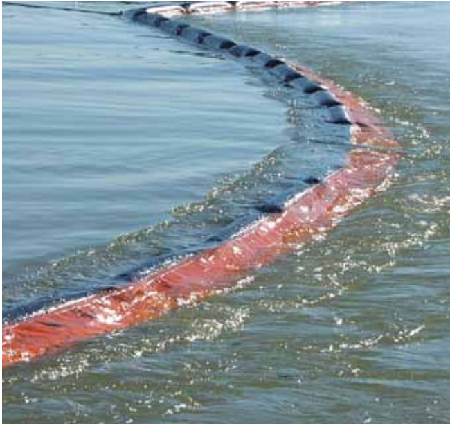
▲ الشكل رقم 4: تسبب التيار القوي في تسطح حاجز التطويق الطافي، مما يتيح فقدان أية كمية من النفط أسفل الحافة المتدلية.
