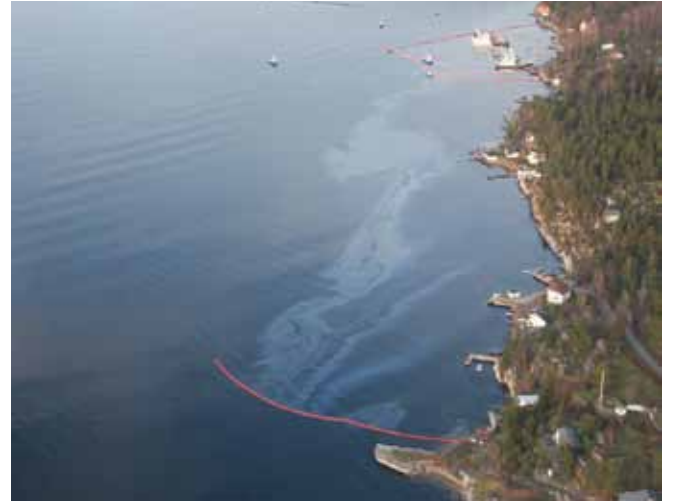
▲ الشكل رقم 14: حاجز تطويق طافي مستخدم كوسيلة دفع لتغيير مسار النفط إلى الشاطئ لاستعادته (© الإدارة النرويجية للسواحل).
