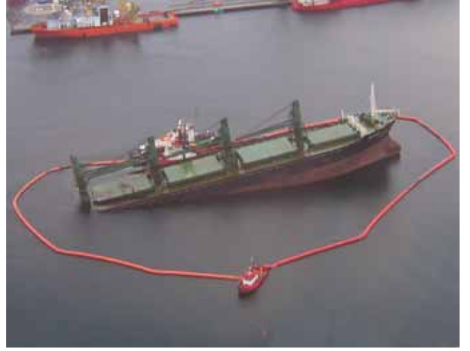
▲ الشكل رقم 12: حاجز تطويق طافٍ قابل للماء بالهواء، تم سحبه ربطه حول حطام سفينة غارقة جزئياً لاحتواء أية تسربات محتملة من وقود السفن.
