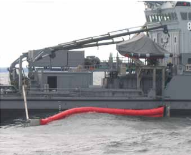
▲ الشكل رقم 11: رغم كونه مرناً بدرجة تكفي لتتبع حركة الأمواج، إلا أن حاجز التطويق الطافي قد ارتفع من الماء في مكان تثبيته بيدن المركب ، مما قد يتيح للنفط الإفلات من قمة الحاجز.
