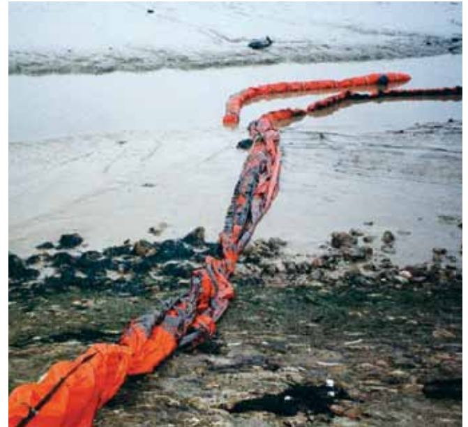
▲ الشكل رقم 5: يمكن أن يتعرض حاجز التطويق الطافي للتلف بسهولة بمجرد تثبيته. العناية المنتظمة مطلوبة لضمان الحفاظ على فعاليته على مدار دورة المد والجزر.
