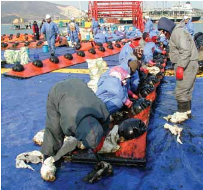
▲ الشكل رقم 6: يمكن أن يشكّل النفط المحتجز خلف وحدات الطفو الخارجية من حاجز تطويق سياجي صعوبة بالغة في التنظيف.
