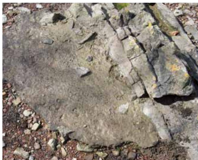
▲ 图 10: 在原油泄漏发生后的一次试验的过程中,有意对受影响海岸线的一个区域不作任何处理。这片油类大约有 1 平方米,在变成沥青路面超过 15 年后依然存在。
