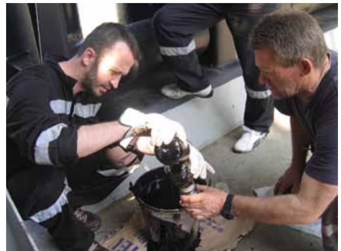
▲ الشكل رقم 4: صب عينة نפט من وقود السفن على سطح سفينة مصابة.
