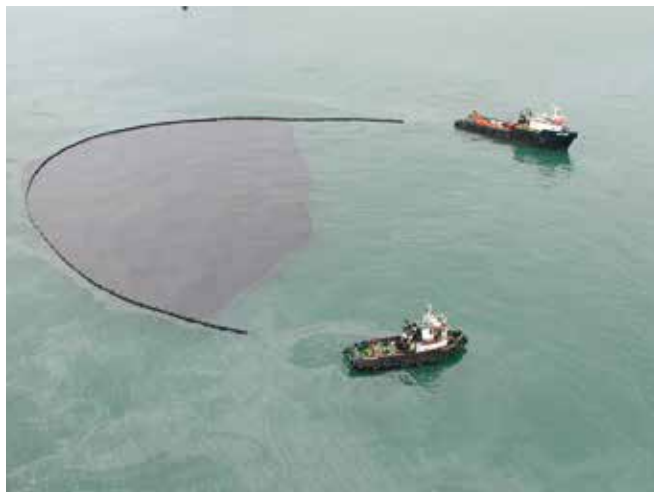
▲ Рис. 5: Проведенное сдерживание нефти может оказаться напрасным в отсутствие средств ее сбора с водной поверхности и накопительных баков для временного хранения собранной нефти.
