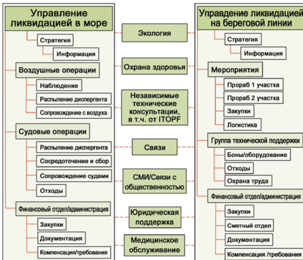
▲ Рис. 3б: Организационная структура на групповой основе с двумя самостоятельными видами деятельности и разделением некоторых функций позволяет руководить морскими и береговыми операциями из двух отдельных командных пунктов, однако требует отлаженной связи между пунктами для успеха ликвидации. В случае небольших аварийных ситуаций некоторые задачи могут объединяться.
