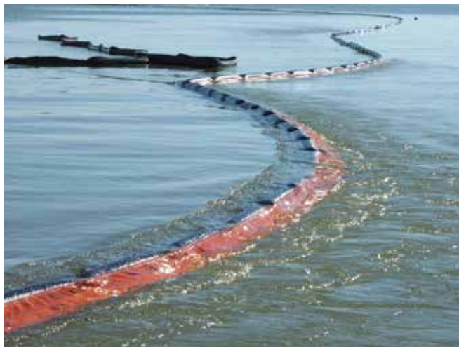
▲ Рис. 4: Осведомленность о предельных возможностях оборудования и окружающей среде, в которой оно работает, помогает избежать потери времени и сил на заведомо неэффективные операции. В данном случае установленные боны не смогут сдерживать нефть из-за сильного течения.
