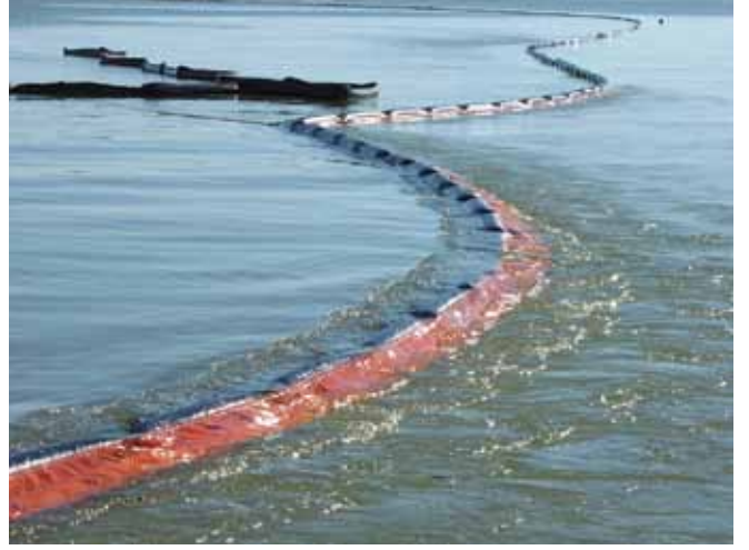
▲ الشكل رقم 4: سوف يساعد الإلمام الكامل بحدود المعدات والبيئات التي يمكن استخدامها فيها على ضمان عدم ضياع الوقت والجهد على الإجراءات التي يمكن التنبؤ بعدم نجاحها. هنا، تعني التيارات المائية العالية أن حاجز التطويق الطافي لن يتمكن من احتواء النفط.
