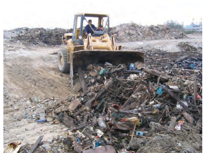
▲ 그림 14: 기름이 부착되기 전에 해안으로부터 폐기물을 제거하는 것은 처리가 필요한 기름 묻은 물질들의 양을 감소시킨다.
