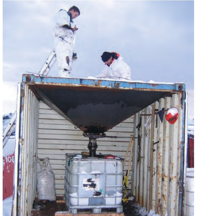
▲ 그림 16: 폐기물을 거르기 위해 회수된 기름이 깔때기를 통과하는 폐기물 여과 시스템.
