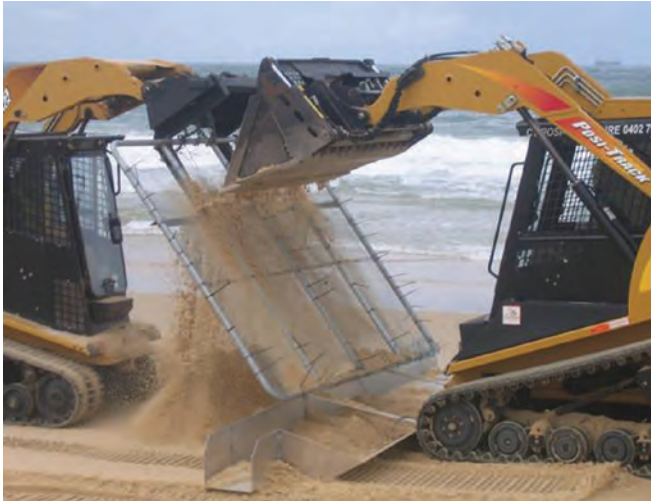
▲ 그림 17: 산출되는 폐기물의 양을 줄이기 위해 기계로 모래에서 타르볼을 거르는 작업.
