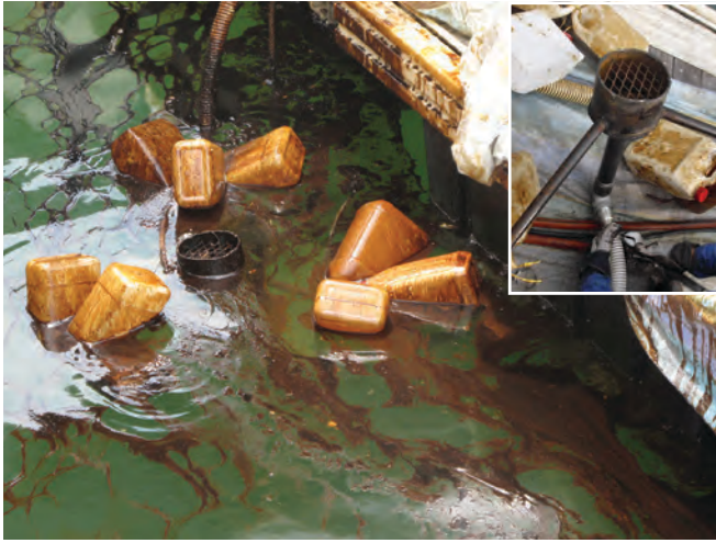
▲ 그림 14: 플라스틱 용기와 금속 조각으로 즉석에서 제작된 위어식 유회수기가 진공 펌프에 부착되어 있다. 이 장치는 초보적인 회수 작업이 가능하며, 용기를 제거하거나 추가함으로써 조정할 수 있다.
