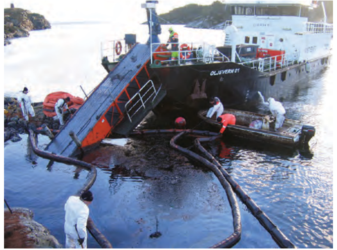
▲ 그림 15: 대형 회수선에 설치된 벨트식 스키머. 망사로 제작된 벨트는 물은 빠져나가고 기름은 부착하도록 설계되어 있다. 선상으로 끌어 올려진 기름은 굽어낸 뒤 저장 탱크로 이송한다.
