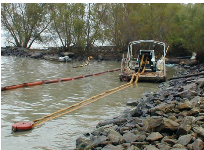
▲▲ 그림 6 및 그림 7: 수평 및 수직 친유성 로프식 유회수기. 서로 엮인 흡착 루프가 하나의 연속적인 몸을 구성하면서 수면에서 기름이 부착된다. 물러로 끌어올린 몸에서 짜낸 기름은 저장 탱크로 이송된다. 로프 몸 유회수기는 쓰레기, 얼음, 기타 장애물과 기름을 분리하여 회수하려는 경우에 유용하다.
