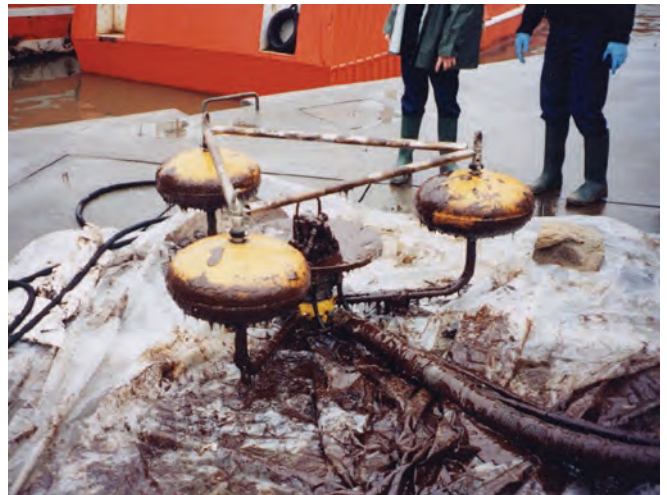
▲ 그림 37: 고점도 기름의 회수 후 해안으로 수거된 위어식 유회수기. 철수 후에는 장비를 세척 및 정비하여 향후 사용에 대비해야 한다.
