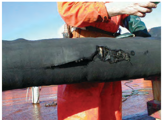
▲ 그림 23: 고점도 기름을 펌핑하는 과정에서 과도한 내부 압력이 발생하여 터진 호스(사진 제공: NOFO)
