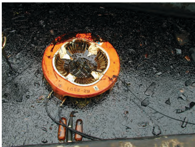
◀▲ 그림 2 및 그림 3: 중점도 기름에 적합한 소형 친유성 디스크식 유회수기. 회전하는 디스크에 부착된 기름을 긁어내어 기름통으로 보낸 뒤 저장 탱크로 펌핑한다. 적절한 펌프와 수압식 전원공급장치를 필요로 한다.
