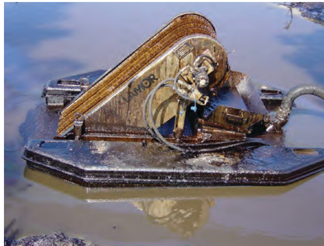
▲ 그림 5: 자유 부양형 브러시식 유회수기. 회전하는 브러시 세트에 부착된 기름이 수면 위로 들어올려진다. 빗 모양의 장치가 브러시에 달라붙은 기름을 제거하여 저장 탱크로 보낸다. 브러시 뒤에 위치한 프로펠러는 유회수기 쪽으로 부유 기름을 유인함으로써 조우율과 처리량을 향상시킨다. (사진 제공: Lamor)
