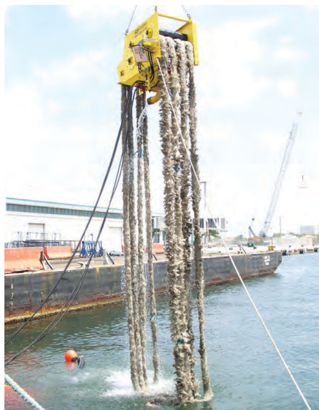
▲ 그림 5: 자유 부양형 브러시식 유회수기. 회전하는 브러시 세트에 부착된 기름이 수면 위로 들어올려진다. 빗 모양의 장치가 브러시에 달라붙은 기름을 제거하여 저장 탱크로 보낸다. 브러시 뒤에 위치한 프로펠러는 유회수기 쪽으로 부유 기름을 유인함으로써 조우율과 처리량을 향상시킨다. (사진 제공: Lamor)
