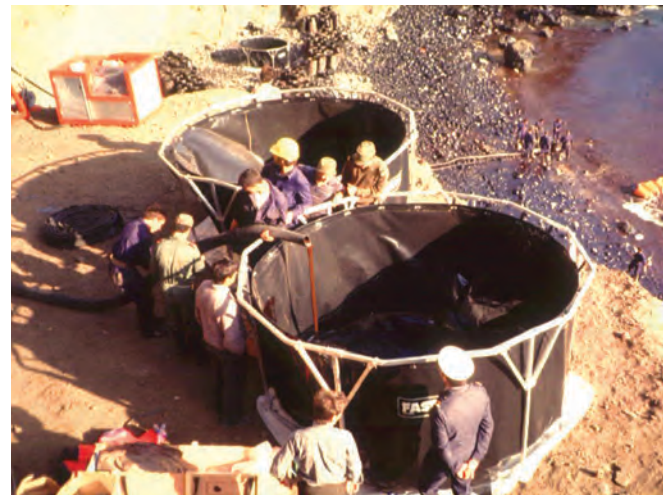
▲ 그림 28: 에멀전화한 연료유가 유회수기를 통해 해안가에서 회수되어 절벽 꼭대기에 있는 임시 저장 탱크로 펌핑되고 있다.
