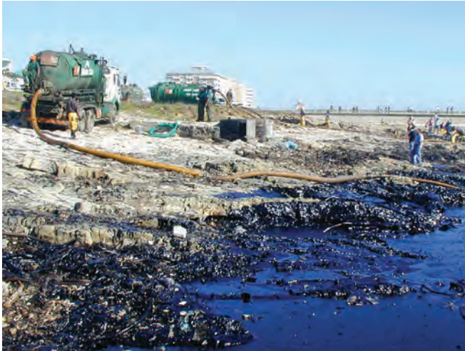
▲ 그림 8: 진공 시스템은 광범위하게 사용할 수 있기 때문에 해안가나 연안에서 기름을 회수할 때 이상적이다.
