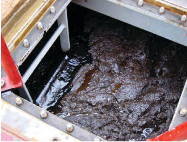
▲ 그림 25: 회수선 내의 저장 탱크에 담겨 있는 고점도 회수유(사진 제공: NOFO)
