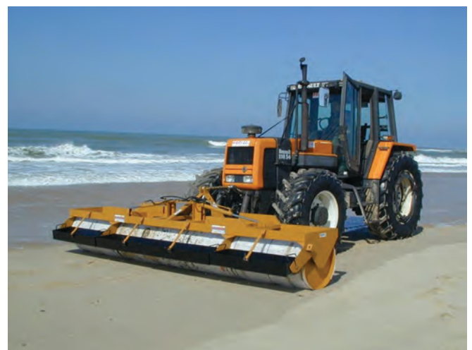
▲ 그림 36: 단단한 모래사장에 있는 타르볼을 회수하는 데 사용되는 트랙터 장착형 친유성 드럼식 유회수기(사진 제공: Le Floch Dépollution).
