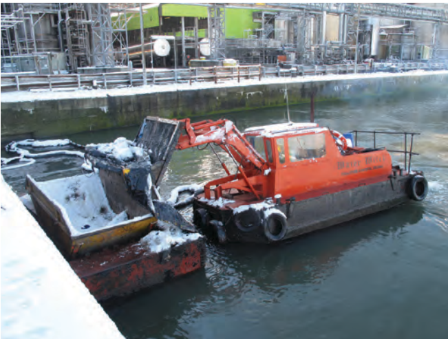
▲ 그림 35: 일반적으로 항구에서 쓰레기를 회수하기 위해 사용되는 자체추진형 선박. 사진에서는 낮은 온도와 비교적 높은 유동점으로 인해 기름이 반고체 상태가 되어 있기 때문에 뜰채와 그레브를 사용하여 유회수기로 회수시켜야 한다.
