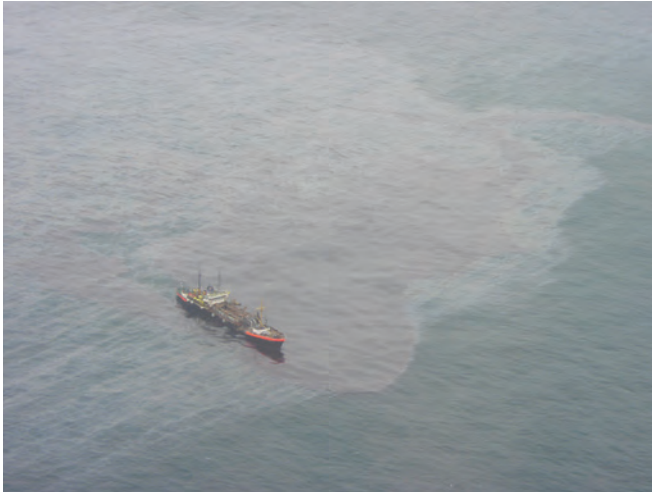
▲ 그림 18: 균일하고 두꺼운 대규모의 유막에서 작업 중인 회수선. 장비와 인력을 대단히 효과적으로 사용할 수 있다.
