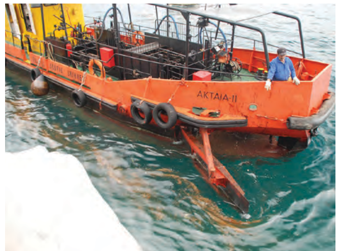
▲ 그림 1: 항구 및 근해에서 사용하는 자체추진형 위어식 유회수기. 회수 폭을 넓히고 부유 기름이 유입될 수 있도록 선수문(bow door)이 개방되어 있다. 회수유는 선내 저장탱크로 이동된다.
