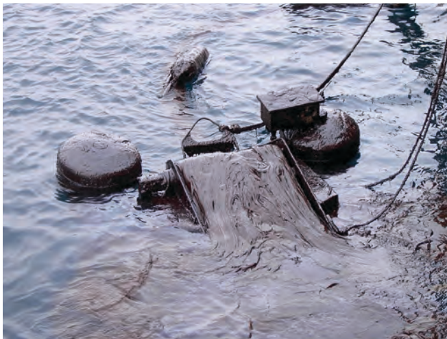
▲ 그림 16: 에멀전화가 심한 인료유의 회수 능력을 향상시키기 위해 위어식 유회수기에 추가된 벨트 어댑터. 고점도 기름은 위어의 주둥이 부분으로 잘 흐르지 않기 때문에, 흡수 모양의 벨트 어댑터를 추가하여 기름을 '붙잡아' 회수 효율을 향상시킨다. 또한 기름의 결속 에너지가 나머지 기름을 회수기 쪽으로 '흐르게' 한다.(사진 제공: Ro-Clean Desmi社/덴마크 해군)
