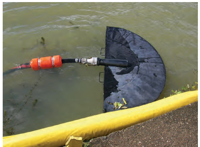
▲ 그림 11: 진공 펌프에 부착된 고정형 위어식 유회수기. 헤드의 가장자리 부분에 작은 입구가 여러 개 있기 때문에 기름을 선별적으로 회수할 수 있다. 잔잔한 바다에서 쓰레기가 아주 적은 경우에 적당하다.(사진 제공: Lamor社)
