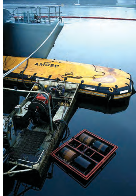
◀ 그림 26: 팽창식 저장바지선으로 기름을 회수하고 있는 드럼식 유회수기
