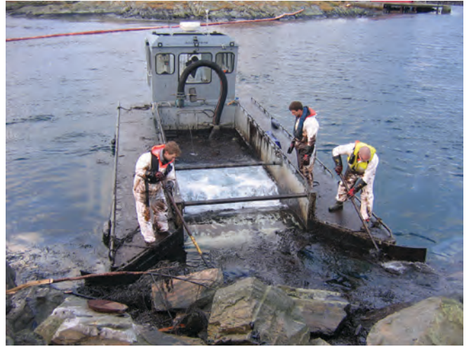
▲ 그림 34: 바위로 이루어져 있는 차폐 지역에서 기름을 회수하고 있는 자체추진형 위어식 유회수기. 흘수가 낮은 회수선은 해안 근처에서 작업이 가능하다. 회수 작업을 보조하기 위해 작업 인원들이 기름을 위어 입구 쪽으로 이동시키고 있다.
