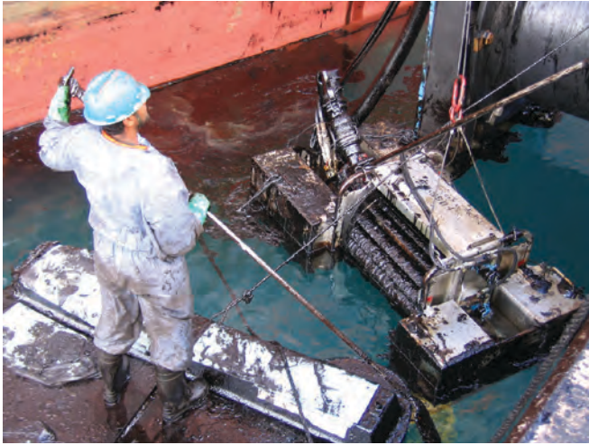
▲ 그림 17: 항구 지역에 배치된 기계적 드럼식 유회수기. 회전 드럼의 톱니에 의해 회수기 쪽으로 유도된 기름은 드럼에서 회수되어 저장 탱크로 이동된다. 드럼은 물 회수를 최소화하기 위해 망사로 제작되었다.
