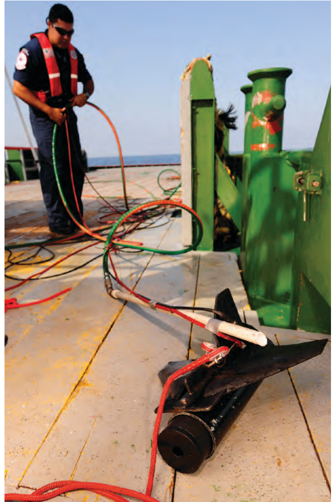
▲ 그림 13: 유처리제의 사용 효과를 측정하기 위해 예인식 형광계를 준비하고 있는 모습(사진 제공: 미국 해안경비대)
