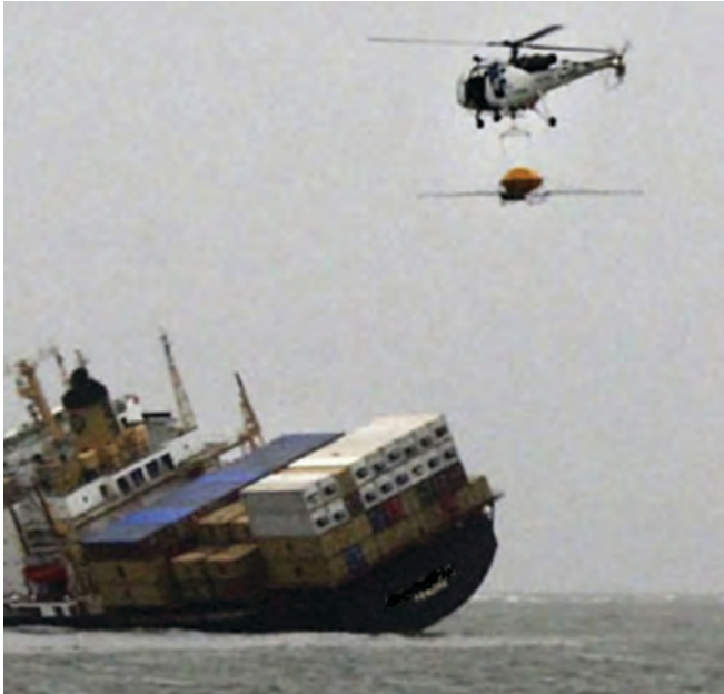
▲ 그림 11: 현수식 스프레이 시스템을 갖춘 헬리콥터가 원유 유출 현장으로 접근하고 있다. 효과적인 방제가 이루어지기 위해서는 저고도에서 유처리제를 살포해야 한다.(사진 제공: 인도 해안경비대)
