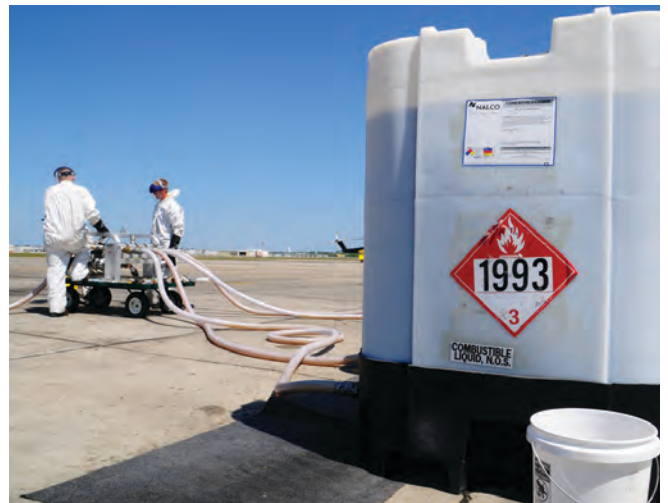
▲ 그림 12: 1 m 3 IBC(Intermediate Bulk Container)를 사용하면 유처리제의 보관 및 취급이 용이해진다.(사진제공:미국해안경비대)
