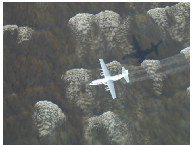
▲ 그림 10: 다발항공기로 유처리제를 살포하는 모습. 이 경우, 천해에서의 살포가 효과적일 것으로 판단되었다.
