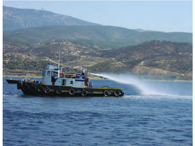
▲ 그림 8: 터그보트에 설치된 방수포를 통한 유처리제 살포. 유처리제가 고르지 못하게 퍼지고 바람의 영향을 받는 모습이다.
