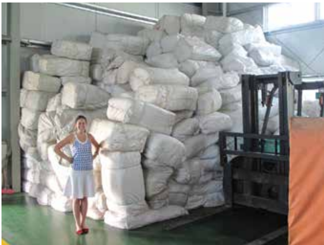
▲ 図8：油吸着素材は、その性質上嵩張るので、流出対応の前、最中、終了後の貯蔵と移送には、後方支援と費用の面で問題が生じる場合がある。
