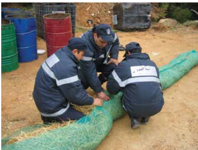
▲ 図2：わらと網から即席で作成した吸着型オイルフェンス。このようなオイルフェンスは安価で、簡単に作れる。しかも、適切な場所に配置すれば短期的保護のために効果を発揮できる。
