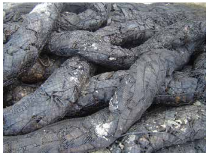
▲ 図3：帯状のポリプロピレンを網で包んだ。ばら素材の不均質なオイルフェンス構造により、油が構造物の中に浸透しやすく、内面で油を吸着することができる。ただし、外側の網は傷みやすい。
