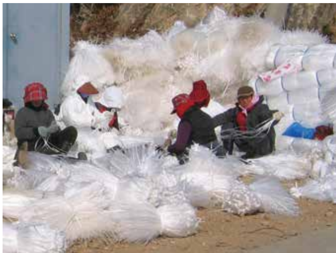
▲ 図6：地元の村人達が帯状のポリプロピレンからスネアを作成している。地元で入手できる素材から油吸着材を作成すると、価格面でも移送効率の面でも費用効果が優れている場合がある。
