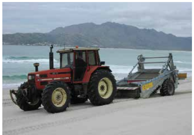
▲ 図26：タールボールを回収中の、トラクターに牽引されるビーチクリーナー。
