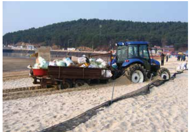
▲ 図39：荷を積んだ車両が柔らかい基層中へ沈む可能性がある。これによって、更なる損害を生じ、油が清浄な堆積物と混じる場合がある。
