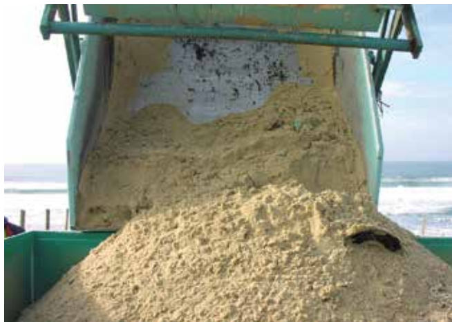
▲ 図7：重機により直接回収したため、汚染されていない物質の割合が非常に高く、廃棄物中の油の濃度が非常に低かった。
