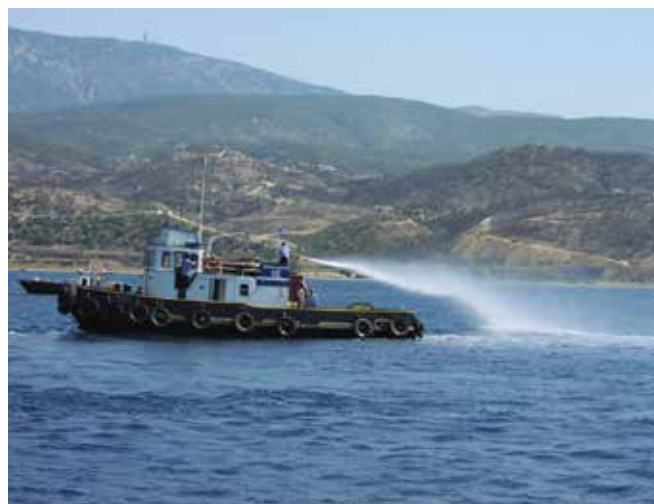
▲ 図8：タグボート上の放水銃を使って油処理剤を散布する。油処理剤の拡散が不均一で、風の影響が見られる。
