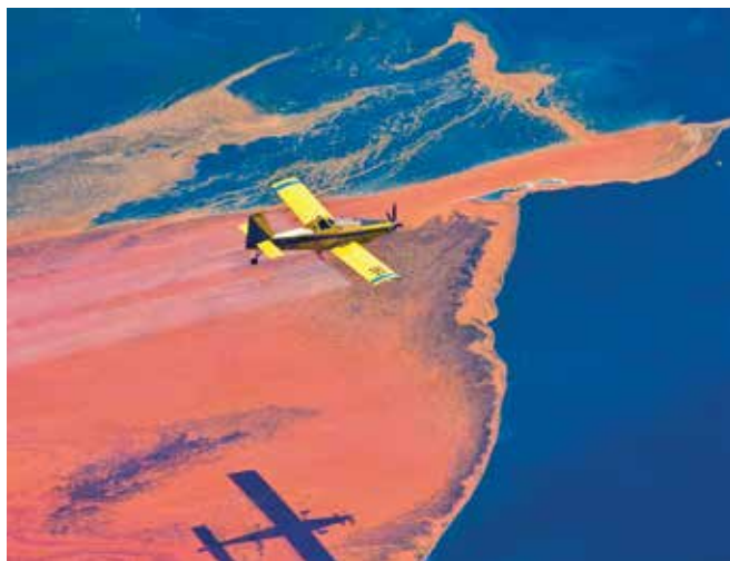
▲ 図9：薬剤散布用飛行機が翼の下の散布ブームから、海上作業台船から流出した原油に向けて油処理剤を散布している。（画像提供：マーク・ハミルトン・フォトグラフィー）
