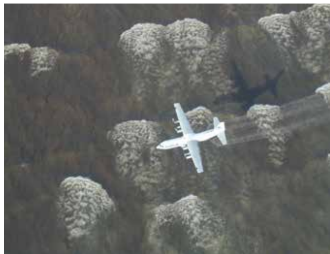
▲ 図10：多発航空機から油処理剤を散布する。この事例では、浅水域での油処理剤の散布が有益と考えられた。
