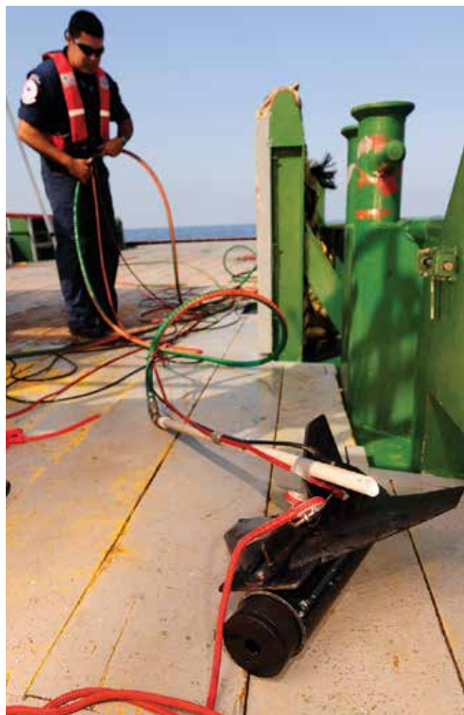
▲ 図13：海上での油処理剤の有効性を計測するため、曳航蛍光光度計を準備する。（画像提供：USCG）
