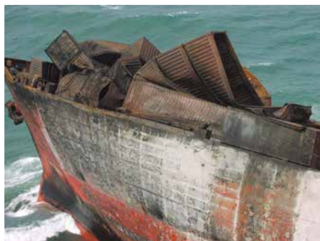
▲ 図9: 座礁したローロー船の船首にある、火災の熱によってつぶれ、歪んだコンテナ。
