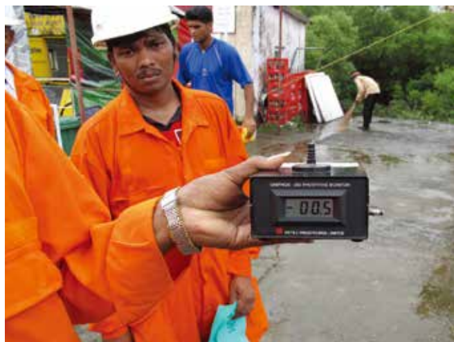
▲ 図14:危険地域の外で行われている手持ち式リン化水素ガス監視装置の実演。
