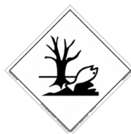
◀ 図10:水生環境有毒性を示す標札。この標札は危険有害性の特定の級に関連している訳ではなく、あらゆる水生環境有毒性物質を輸送する際に用いられる。
