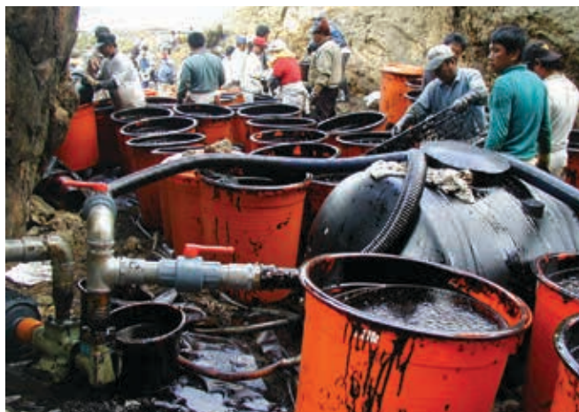
▲ Figura 13: almacenaje temporal de hidrocarburos recolectados en una costa rocosa en grandes recipientes abiertos. Se necesitaron bombas para transferir estos hidrocarburos hasta la parte superior del acantilado y, a continuación, hasta camiones cisterna.
