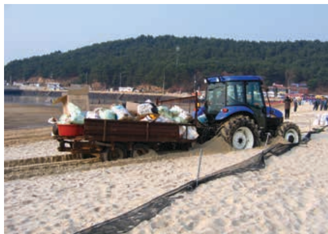
▲ Figura 39: los vehículos cargados pueden hundirse en sustratos blandos. Esto puede provocar daños adicionales y la mezcla de hidrocarburos con sedimentos limpios.
