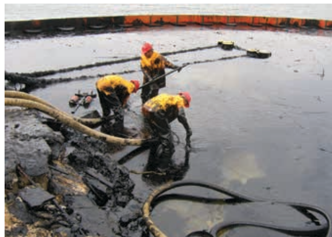
▲ Figura 3: recolección de acumulaciones de hidrocarburos de la costa mediante un skimmer tipo fregadora de cuerdas y bombas de aspiración.
