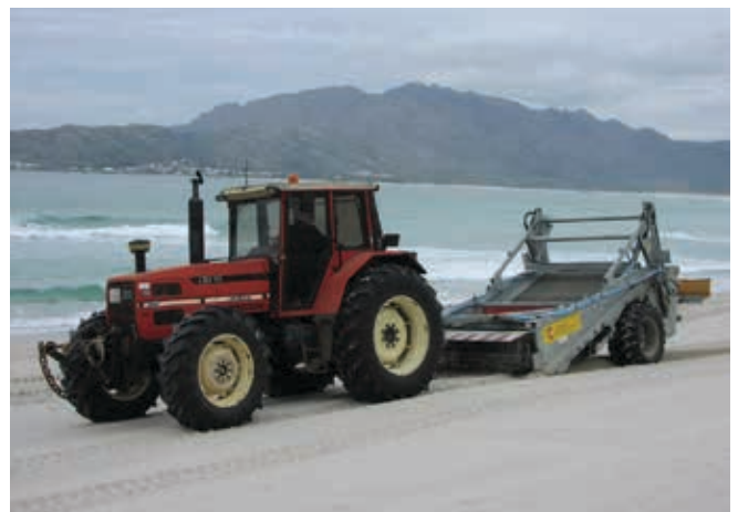
▲ Figura 26: recolección de bolas de alquitrán mediante una máquina de limpieza de playas remolcada por un tractor.
